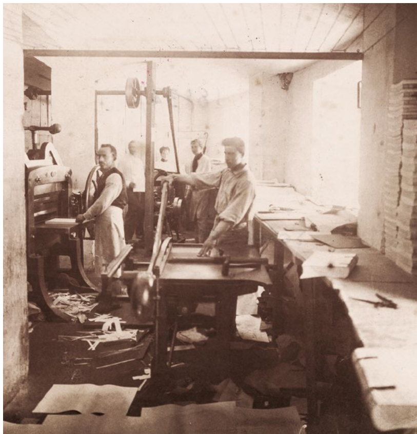
Sección de encuadernación. En primer plano se puede ver la cizalla que aún persiste en el lugar (Archivo General de la Nación).
