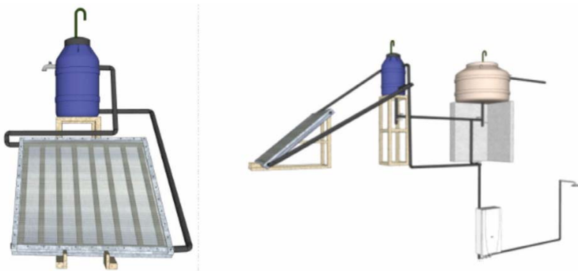
Fig. 9: Prototipo ubicado en el suelo sin conexión a tanque de reserva y en el techo con conexión a tanque.
