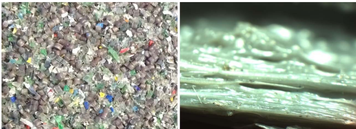
Fig. 1. Mezcla triturada previa a la extrusión (izquierda) Mezcla extruida (derecha).
