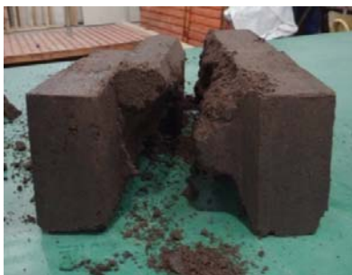
Fig. 10. Rotura longitudinal del BTC
