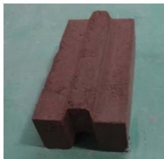
Fig. 7. BTC producido por la prensa electromecánica.
