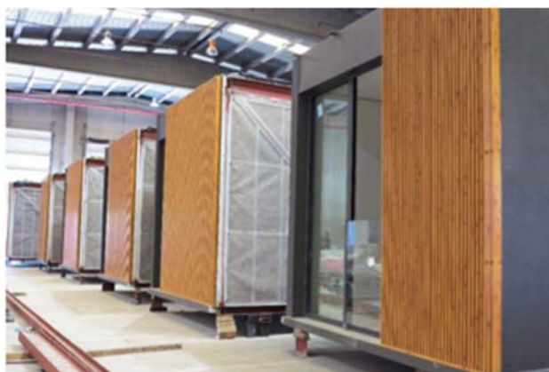
Fig 5: Arquitectura industrializada, módulos terminados
