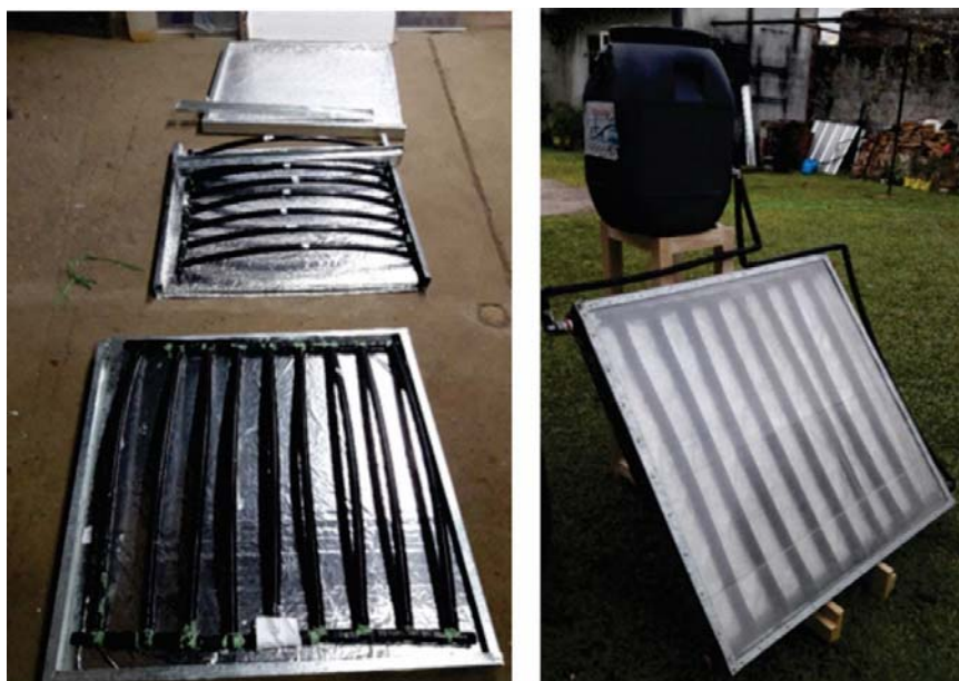
Fig. 6: Calentadores armados en los talleres y sistema completo con prototipo y tanque acumulador de agua caliente.
