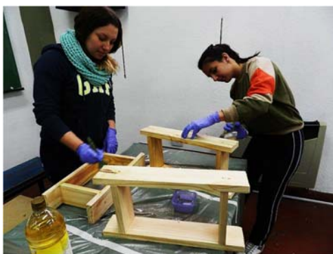
Fig. 4 y 5. Armado de moldes (Fuente: Obtención propia)
