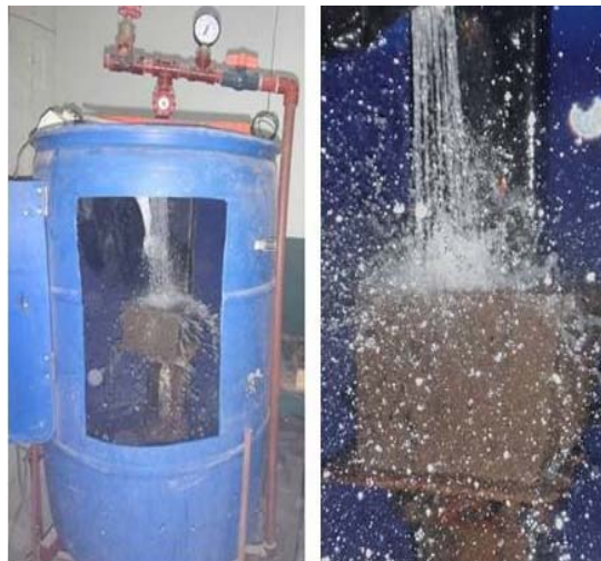
Fig 9. Ensayo de erosión húmeda
