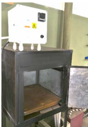
Figs. 8 y 9: Termoprensa y molde fabricados en la FRTL UTN
