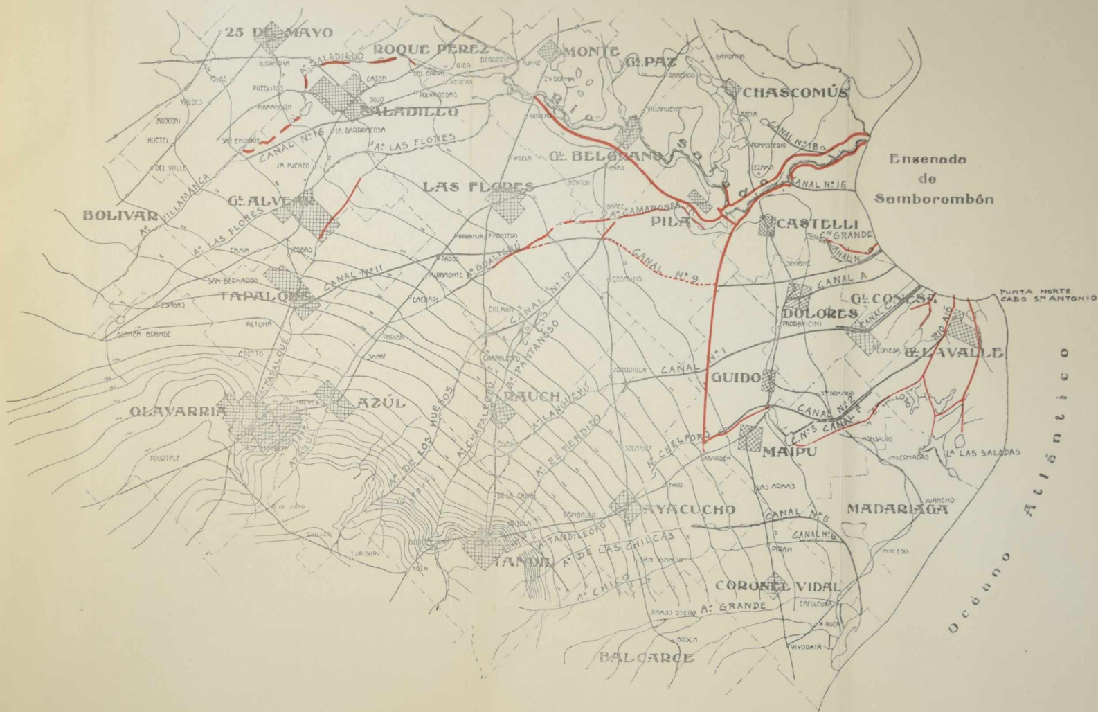
Figura 153 Plan del ingeniero M. Arce. Año 1919 Base del Plan de Drenaje, Desviación y Endicamiento del Salado
