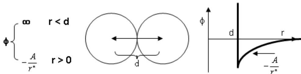
Fig. II.5: Potencial de interacción para esferas duras atractivas.
