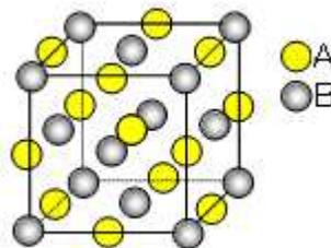
**Fig. 20.36:** Distribución de las partículas para una red del tipo conocido para NaCl.
