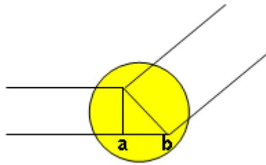
**Fig. 20.26:** Desfasaje de la radiación debido a la distribución de carga en la partícula con la que interactúan los rayos X.
