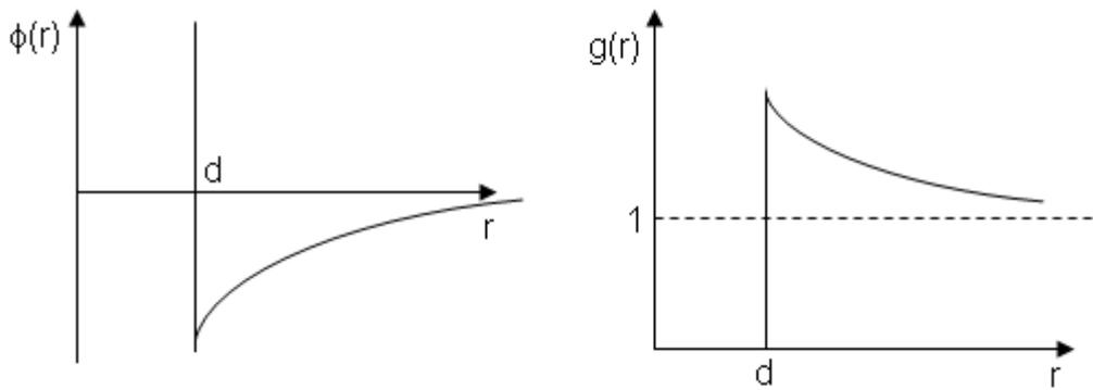
**Fig. 21.6:** Potencial de interacción para esferas duras con un potencial atractivo y la correspondiente función de distribución radial.
