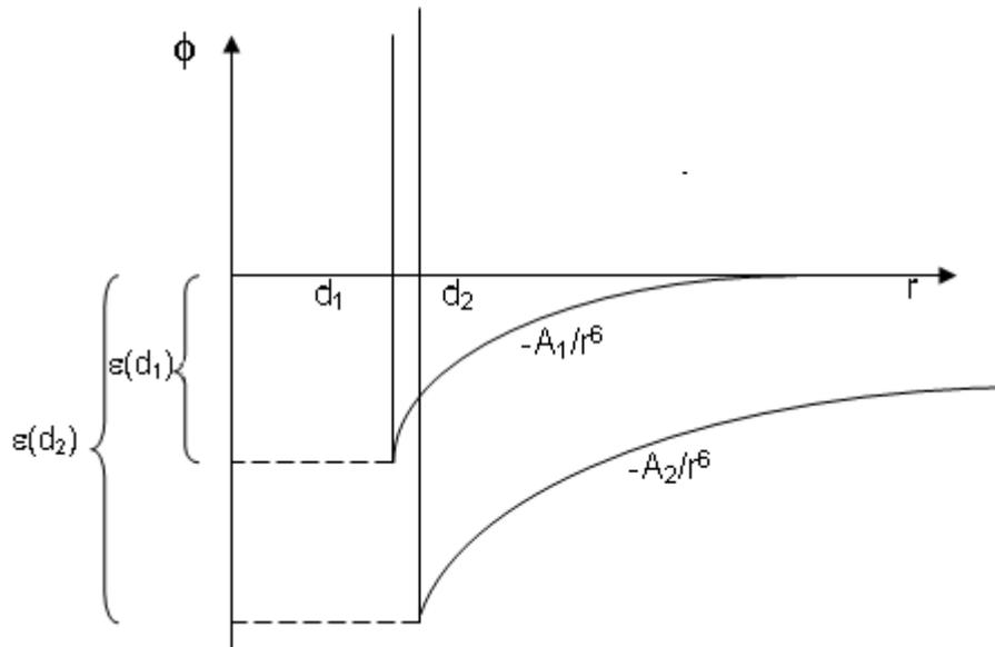
**Fig. II.6:** Comparación de dos curvas de energía potencial para dos gases con  $A_1 < A_2$ . En el gas 2 las moléculas experimenta fuerzas de atracción mayores y por lo tanto la energía potencial disminuye en una mayor extensión que en el gas 1.
