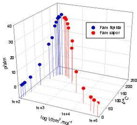
**Fig. 1.6:** Para esta representación se emplearon densidades de las fases líquidas y vapor en equilibrio para éter etílico. Fuente: J. Timmermans, *Physicochemical Constants of Pure Organic Compounds*, Elsevier, 341, (1959).
