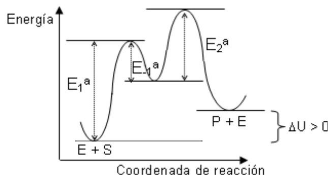
**Fig. 19.14:** Perfil de energía para la reacción enzimática, donde se observan dos estados activados asociados con el mecanismo sencillo de Michaelis-Menten.
