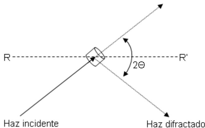
**Fig. 20.18:** *Dispersión de la radiación por un cristal.*
