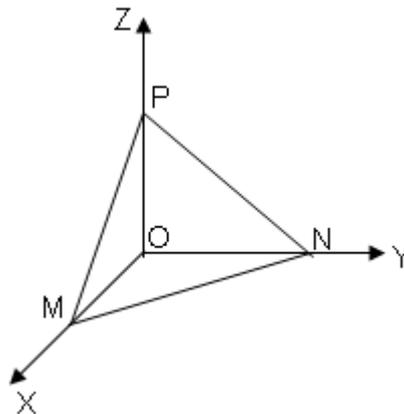
**Fig. 20.6:** Plano de trabajo y su intersección con los ejes cristalográficos.
