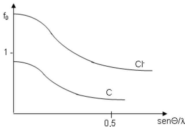
**Fig. 20.27:** Representación del factor atómico  $f_0$  en función de la relación  $\text{sen}\theta/\lambda$ .
