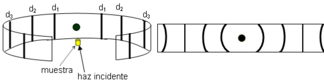
**Fig. 20.22:** Disposición geométrica de la muestra y la película. Las líneas  $d_n$  corresponden a la intersección de la radiación difractada con el film. A la derecha se muestra el film extendido con las franjas observadas. La mancha en el centro corresponde a la radiación no difractada.
