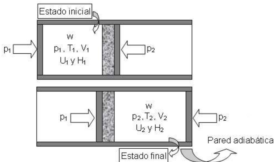
**Fig. 8.6:** Representación esquemática del proceso de Joule-Thomson
