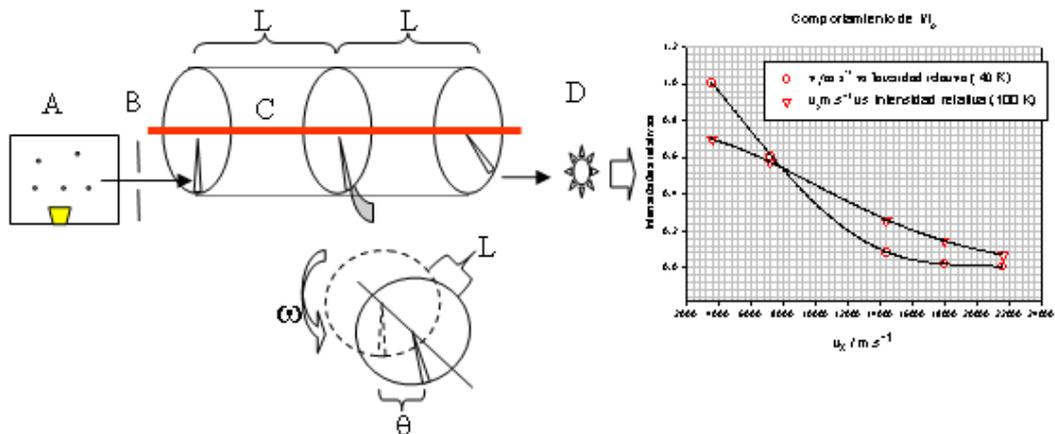
**Fig. 3.24:** (a) Esquema de un equipo selector de velocidades (b) Ilustración entre los resultados de un experimento a dos temperaturas (40 K y 100 K) y los comportamientos esperables para la función de distribución de la componente  $v_x$ . Se observa una buena concordancia entre los resultados experimentales y la teoría (línea). Los valores están normalizados.
