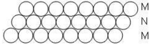
**Fig. 20.39b:** Disposición de una segunda capa de partículas en un empaquetamiento MNM
