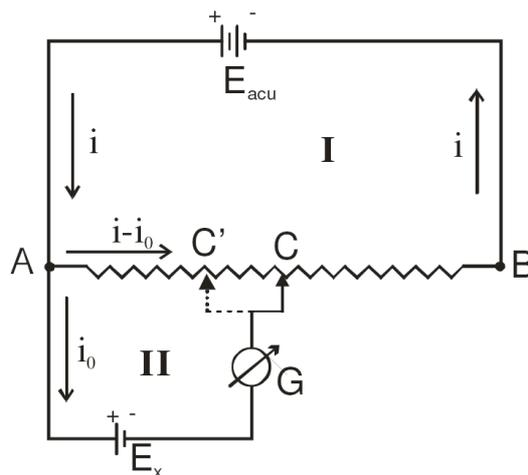
**Fig. 15.2:** Esquema básico de un circuito de Poggendorff
