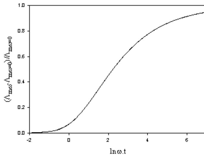
**Fig. 18.22:** Incremento relativo de la conductividad molar para un electrolito 1:1 como función de la frecuencia del campo eléctrico. Fuente: Hans Falkenhagen, J.W. Williams, *J. Phys. Chem.*, 33 (1929), 1121-1134
