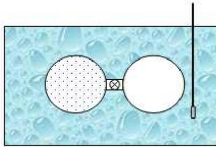
**Fig. 5.11:** Esquema simplificado del experimento de Joule.
