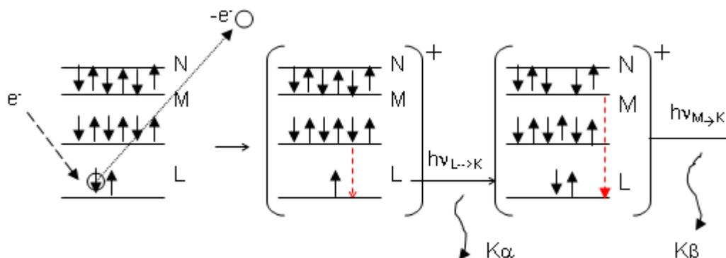
**Fig. 20.20:** Esquema de las transiciones internas que dan lugar a la radiación X ( $K\alpha$  y  $K\beta$ ) como resultado de la vacancia en la capa L generado por el haz de electrones incidentes.
