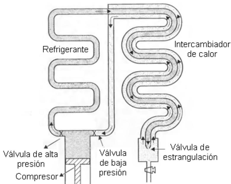
**Fig. 8.10:** Esquema básico de una máquina para enfriar gases y condensarlos sobre la base del experimento de Joule-Thomson. Ref: M. Zemansky, "Calor y Termodinámica", Ed. Aguilar (1973).
