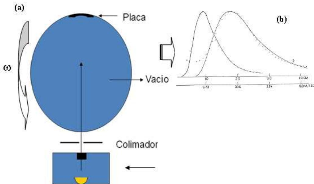
**Fig. 3.23:** (a) Esquema del equipo empleado por Zartman y por Ko. (b) revelado del depósito ( $I/I_0$ ) en el que se resuelven las funciones de distribución de Bi como función de la distancia al extremo de la placa (en cm) para dos velocidades rotación distintas 120,7 y 241,4 rps a 851°C. Cuando mayor es la velocidad de rotación más angosta es la distribución. Obsérvese que al duplicar las revoluciones por segundo, el máximo se corre de 2 a 1 cm. (Zartman. *Phys. Rev.* **37** (1931), 389).
