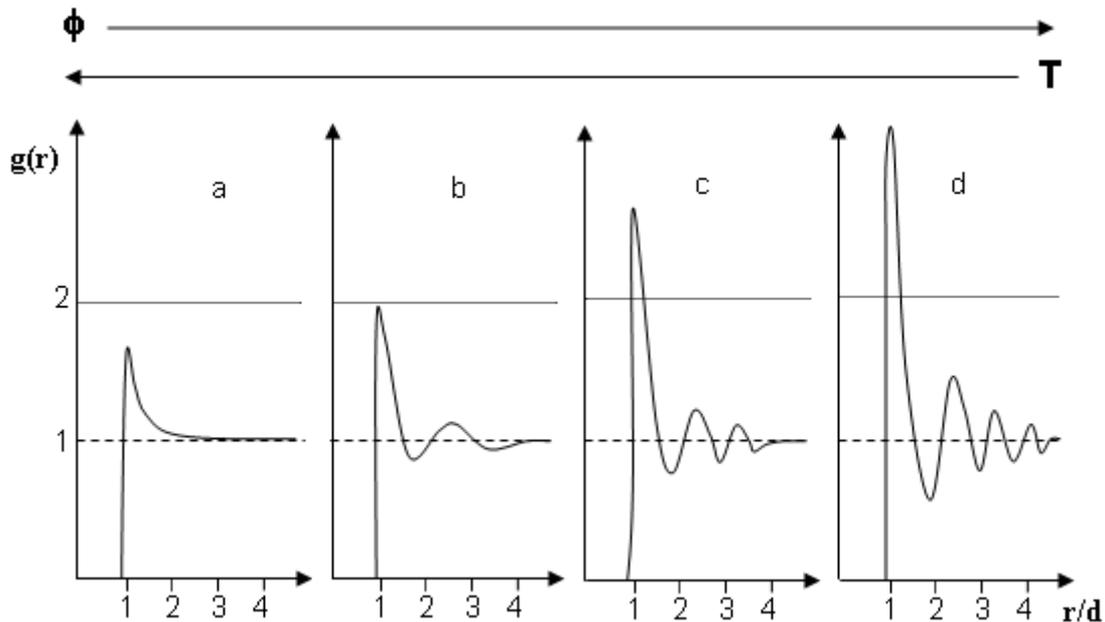
**Fig. 21.12:** Los comportamientos esquematizados corresponden a situaciones del orden de a)  $\rho = 0,1 \cdot 10^{-3} \sigma^3$  y  $\varepsilon = 0,5 kT$  (b)  $\rho = 0,6 \cdot \sigma^3$  y  $\varepsilon = 0,25 kT$  (c)  $\rho = 0,6 \cdot \sigma^3$  y  $\varepsilon = kT$  (d)  $\rho = \sigma^3$  y  $\varepsilon = 0,5 kT$ .
