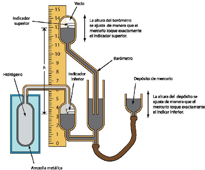
**Fig. 5.3:** Esquema de un termómetro de gas con carga de hidrógeno.
