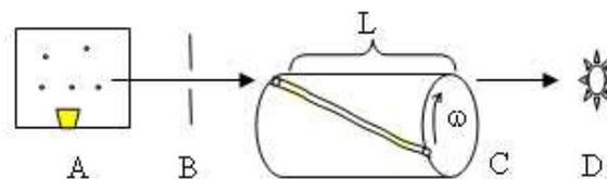
**Fig. 3.25:** Selector alternativo de velocidades moleculares.
