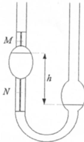
**Fig. 17.7:** Viscosímetro tipo Ostwald
