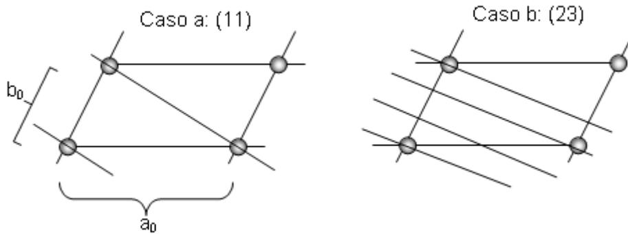
Fig. 20.33: Arreglo bidimensional en el que se esquematiza la distribución de planos (11) y (23).
