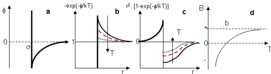
**Fig. II.11:** Comportamiento de los términos presentes en la ecuación de Rayleigh para un potencial de esferas duras sin atracción.
