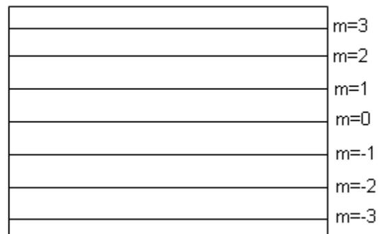
**Fig. 20.15:** Distribución de los patrones de difracción sobre la placa extendida.
