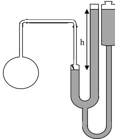
**Fig. 2.2:** Esquema básico de un termómetro de gas
