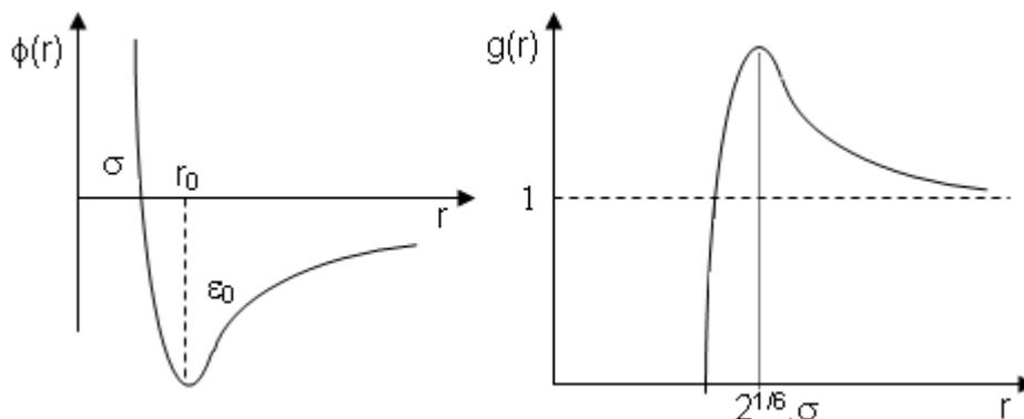
**Fig. 21.17:** Potencial de Lennard-Jones y la función de distribución radial correspondiente.
