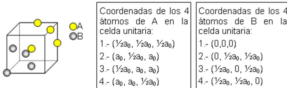
Fig. 20.37: Asignación del número de partículas por celda unitaria en una red tipo NaCl.
