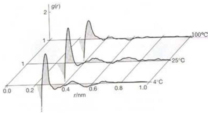
**Fig. 21.11:** Función de distribución radial de átomos de oxígeno en agua líquida a 4, 25 y 100°C. Obsérvese el incremento en el ancho de  $g(r)$  y la desaparición paulatina del grado de estructura del líquido.
