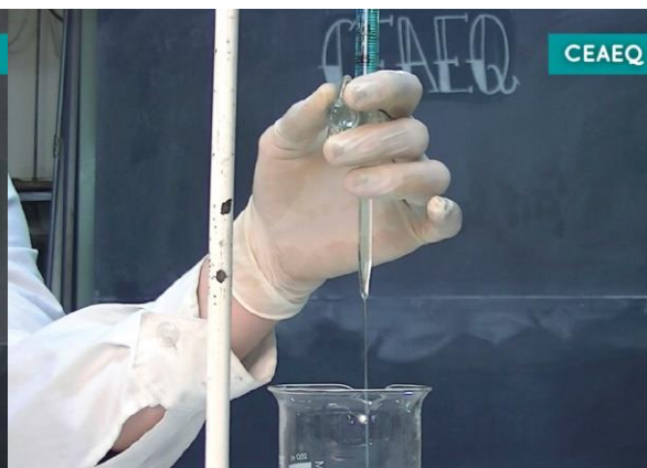
Correcta utilización de una bureta.
