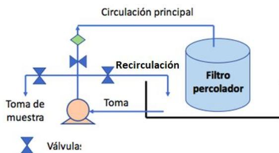
Figura 1. Diagrama del diseño del filtro percolador.
