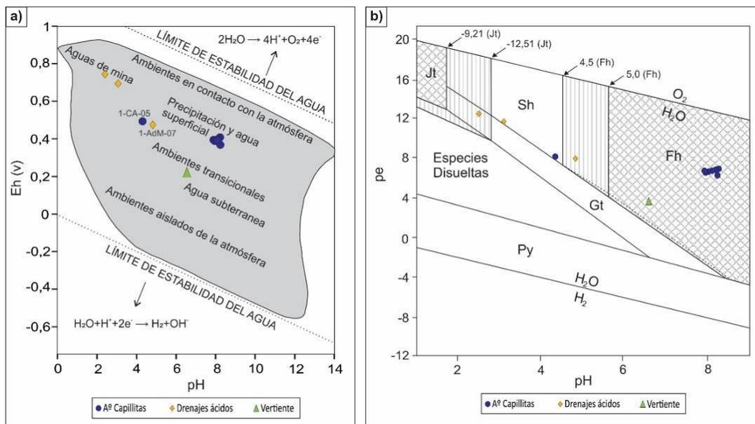
Figura 3. **a)** Campos de estabilidad de diferentes ambientes naturales (Modificado de Becking *et al.*, 1960). **b)** Diagrama pe-pH para minerales de Fe-S-K-O-H, donde: pe= (Eh mV/59,2), Py=pirita, Gt= goethita, Fh=ferrihidrita, Sh=schwertmannita, Jt=jarosita. (Modificado de Bigham *et al.*, 1996).
