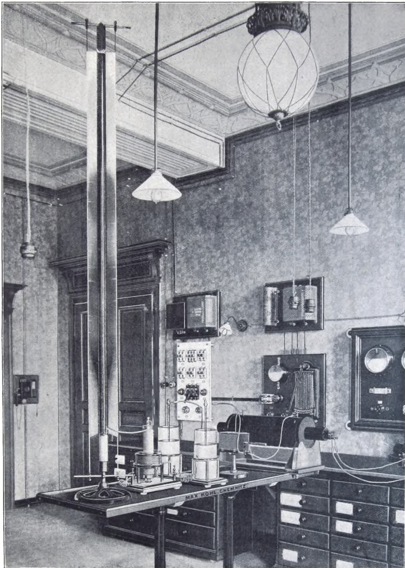
No. 28060—28066 a. Apparat zur Demonstration der Resonanz elektrischer Wellen in der Anordnung der Telegraphie ohne Draht nach Prof. Braun. Stehende leuchtende Wellen. \frac{1}{12} nat. Größe.
