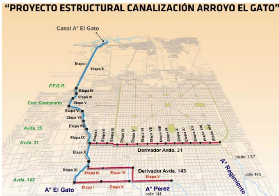
Figura 3. Proyecto estructural canalización A° El Gato (Fuente: MlySP-PBA, 2013).
