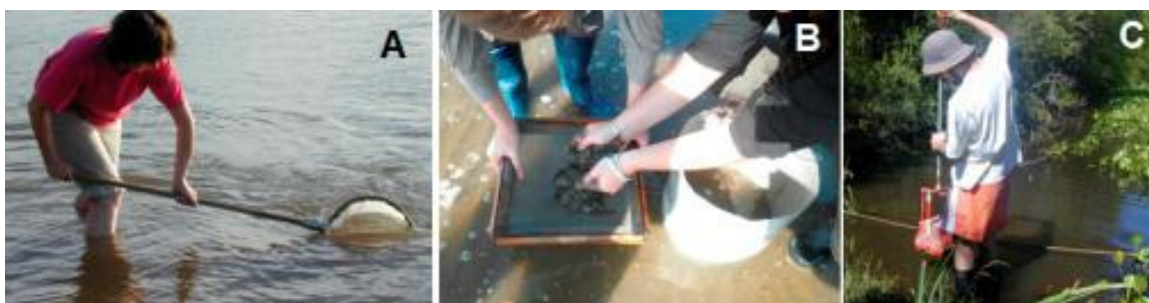
Figura 3. Muestreo sobre distintos tipos de sustratos blandos. A: copo aplicado para obtener organismos del bentos superficial en fondo areno; B: cilindro de 0,07m 2 de superficie, aplicado sobre sustrato blando y capa de agua no profunda; C: utilización de draga manual tipo “Ekman”, sobre sustrato blando.
