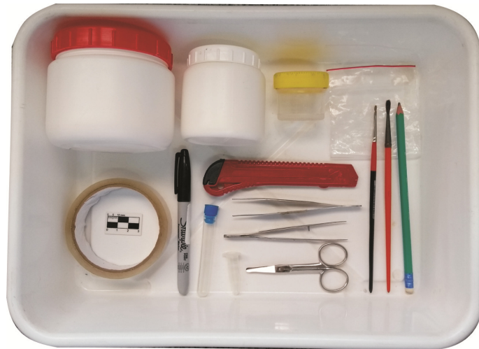
Figura 5. Algunos materiales que deben llevarse para el viaje de campo: bandeja plástica, frascos (500 ml, 250 ml, 40 ml), pinzas, lápiz, fibra indeleble, escala, pinceles, bolsa con cierre hermético, cinta adhesiva, tijera, trincheta.
