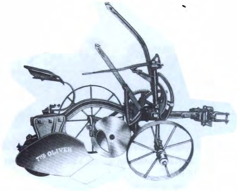
Fig. 7 El arado de asiento, introducido a fines del siglo XIX, alivió sensiblemente el pesado trabajo de arar con arado de manquera, donde el arador debía caminar detrás del arado.
