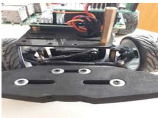
Figura 3: Sistema de direccionamiento del Auto-Robot
