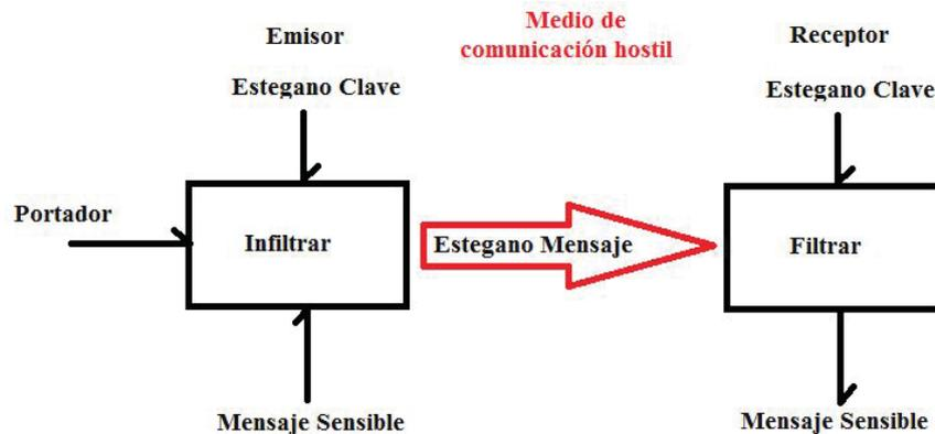
Fig. 1. Arquitectura de una comunicación esteganográfica.
