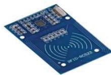
Fig. 3. Módulo RFID 13.56MHZ (lector de tarjeta)
