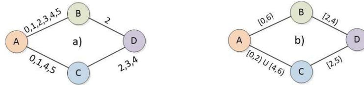
Figura 2: a) Etiquetado con secuencia de contactos. b) Etiquetado con Intervalos de validez.
