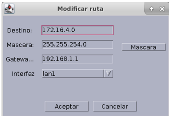
Figura 8: Modificación de ruta de la interfaz lan1
