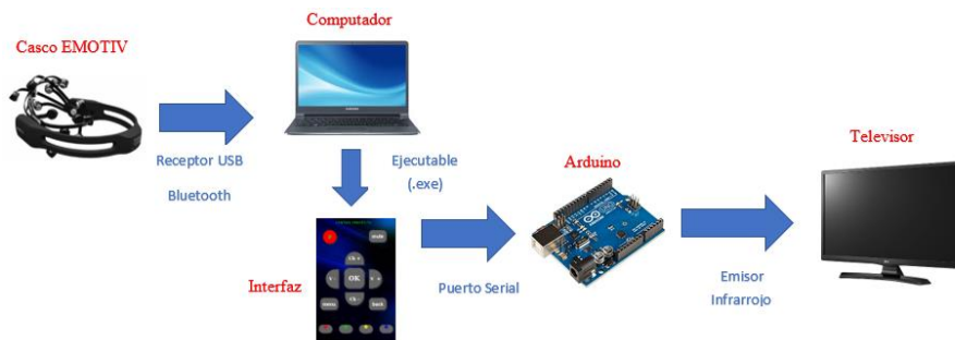
Fig. 5. Proyecto implementado en su totalidad.
