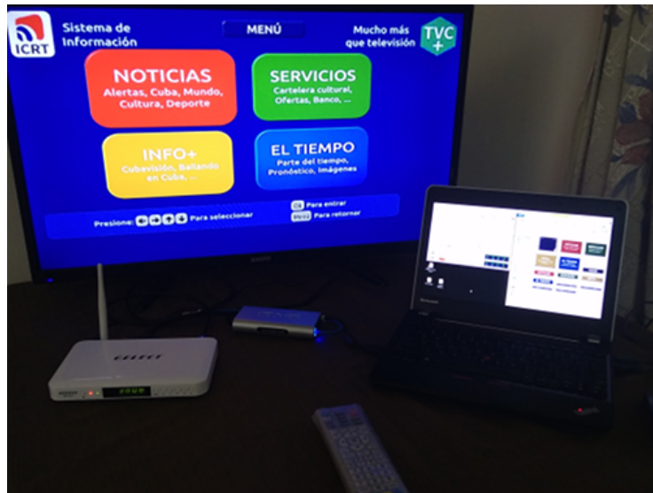
Figura 4. Escenario de prueba donde se muestra el modulador (en el centro) que transmite la señal generada en la PC y finalmente se visualiza en el TV desde el STB.
