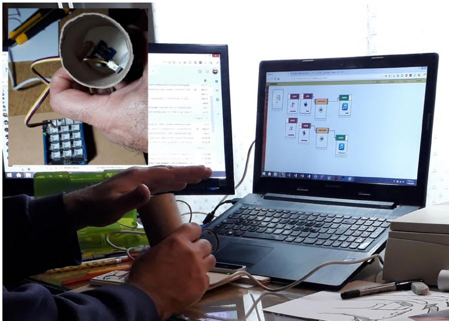
Figura 2: Demostración del caso Reproductor de Audio: construcción y prueba de boceto con hardware (con Arduino, sensor LDR y acelerómetro) y modelo de bloques en Cuaderno de Pluma
