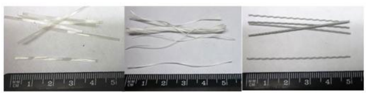
Figura 109. Macrofibras sintéticas para el refuerzo de hormigones. Elaboración propia.
