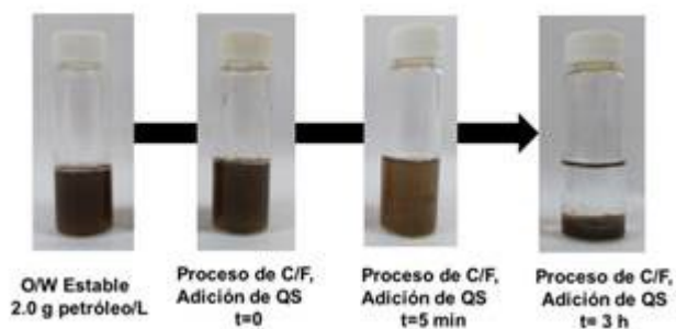
Figura 72. Evolución en el tiempo de una emulsión aceite agua (O/W) formulada con 2.00g petróleo/L y 0.77g/L de SDS.
