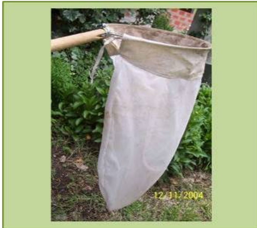
Figura 7.8: Trampa de Red, utilizada para la captura de la fauna epífita. Foto de los autores.
