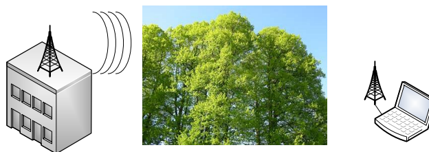
Figura 2. Transmisión de Señal con punto de prueba afectado por vegetación tupida de árboles
