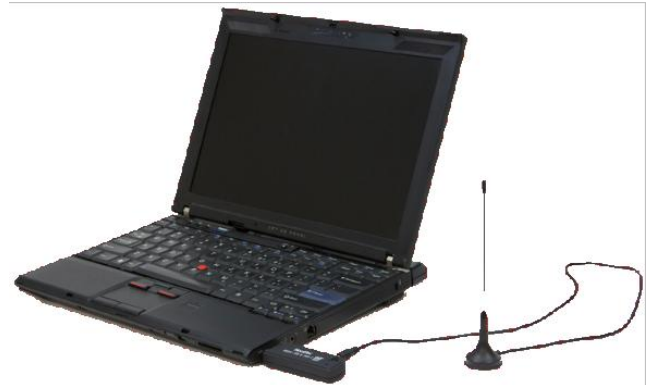
Figura 2. Disposición de equipo para recepción de señal de Televisión Digital y desarrollo de medidas y pruebas.
