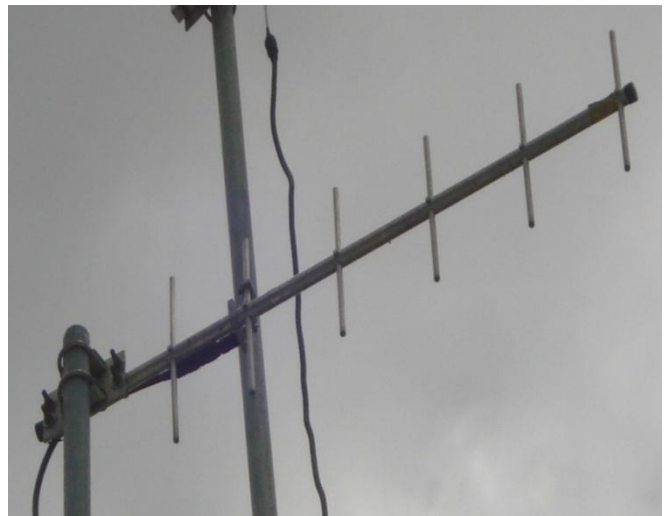
Figura 10. Antena Yagui gamma match en polarización vertical orientación oeste.
