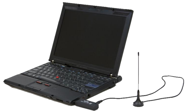
Figura 8. Disposición de equipo para recepción de señal de Televisión Digital y desarrollo de medidas y pruebas.
