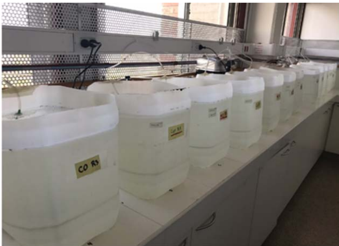
Figura 11.9: Mesocosmos de 30 L para evaluar los efectos de glifosato y cipermetrina aislados y en mezcla sobre el plancton.
