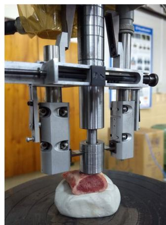
Figura 3: Disposición de extensómetro en la máquina de ensayos. Izq.: vista general. Der.: vista ampliada del instrumento y del hueso
