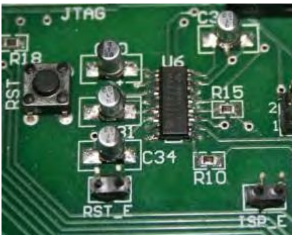
Figura 6. Detalle de los jumpers de programación y la interfaz RS232.
