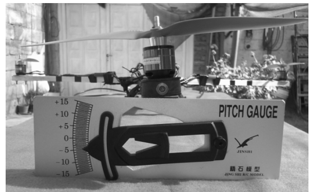
Figura 5. Medición del ángulo de inclinación (4.5°) del motor de cola
