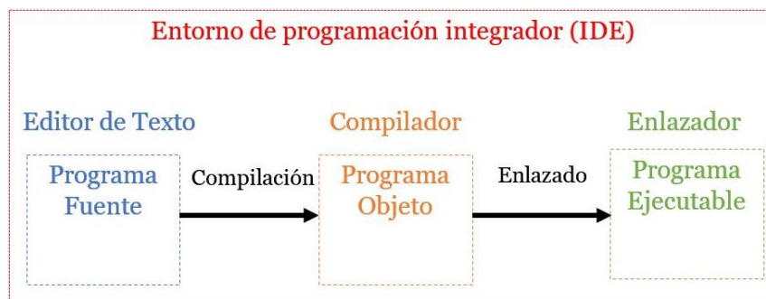
Figura 3.5. Etapas del proceso de compilación en C
