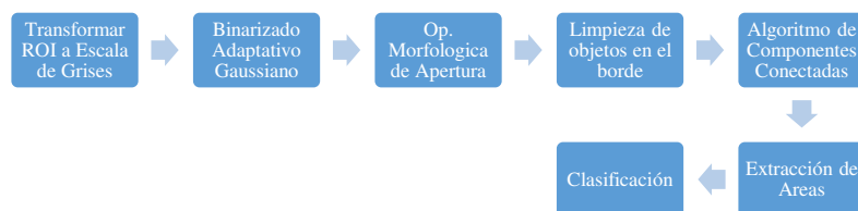
Fig. 3. Secuencia de procesamiento del método basado en umbralización adaptativa.
