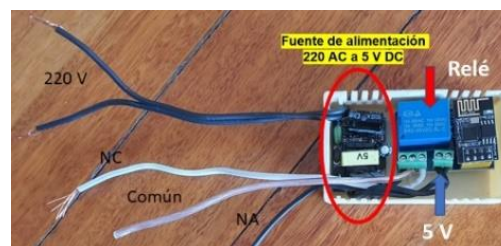
Figura 2. Caja contenedora del módulo Relay con el ESP01s más la fuente de alimentación
