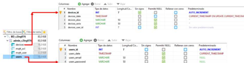
Figura 4. Tablas users y devices de la base de datos admin_c2ing076 en MySQL
