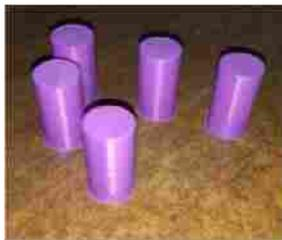
Fig.11 – Probetas para compresion ABS
