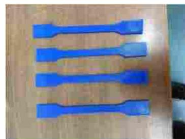
Fig.8 – Probetas para tracción PLA
