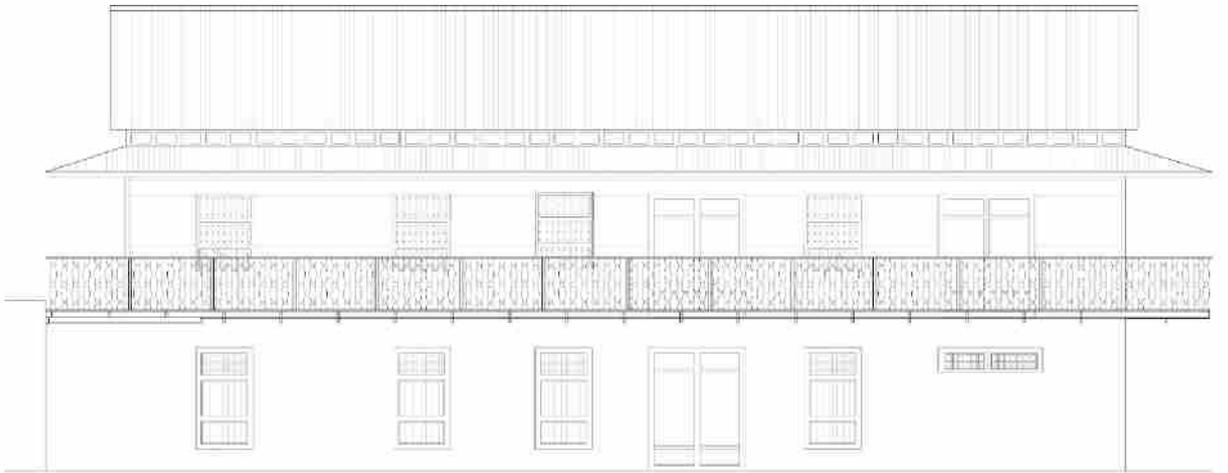
**Figura 4– La fachada de Casa Berrocal, en relación con la escala de representación, presenta una información relacionada con su real condición (falta de horcones, elementos transformados a través intervención o falta de manutención)**
