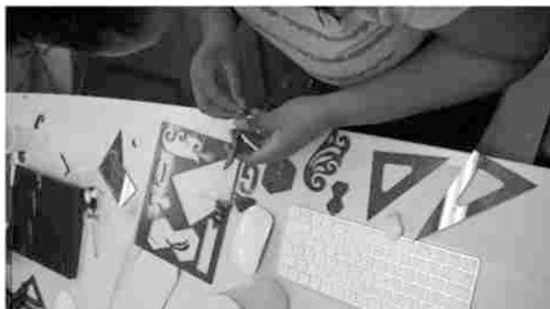
Figura 3. Instrumentos cortados no acrílico a laser.
