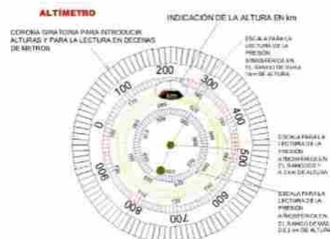
Fig.3. Altímetro. Realiza la nivelación barométrica ejecutada a partir del Reloj de Sol emplazado en La Facultad de Ciencias Agrarias
