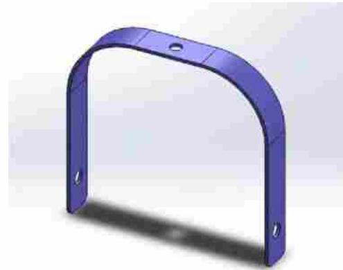
Figura 13: Banda de tiro vinculada al eje de la rueda delantera.
