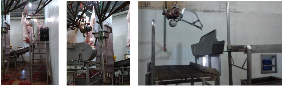
Imagen 15, 16 y 17. Palco de eviscerado con troneras de vísceras y sierra de corte de la res. Frigorífico Pueblo Chico de Chascomús.
