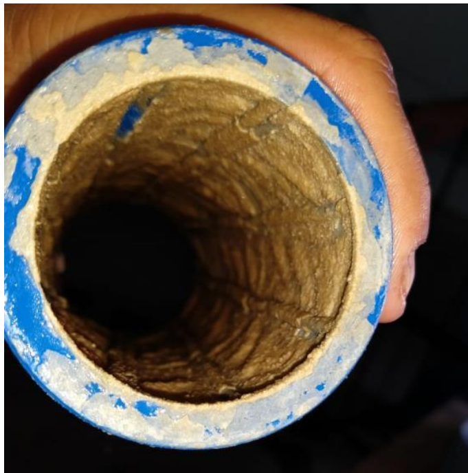
Foto 4. Biofilm. Las incrustaciones de material calcáreo favorecen la fijación de colonias de microorganismos.
