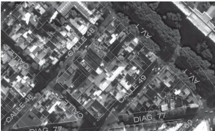
Figura 11. Dibujo de las edificaciones con programa AutoCAD sobre imágenes de Google Earth.
