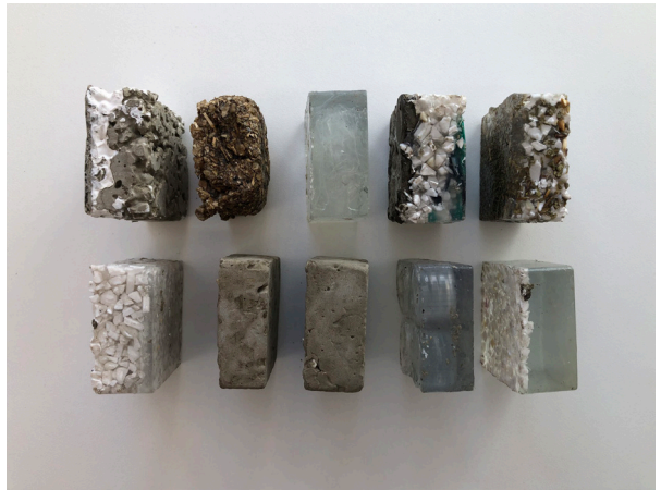
Ensayos de dosificación de materiales. B20 - Barrio 20 | Bloque 20. UCCI – IVC – Estudio Arqtipo. Año: 2020, Elab. propia. / Ensayos de dosificación de materiales a partir de la experimentación. Re materializar. Año 2021. Elaboración propia.
