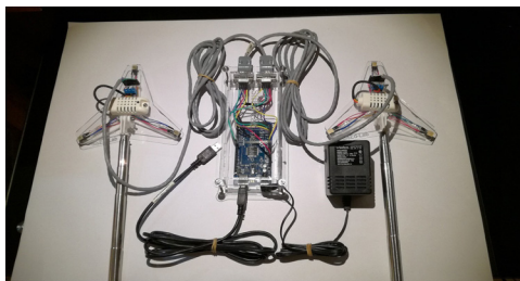
Figura 1. Fotografía de los componentes físicos del equipo: dos sondas, una placa electrónica con cables para conectar a una computadora y una fuente de alimentación. Figura 2. Caja de adquisición de datos con placa Arduino Mega 2560.
