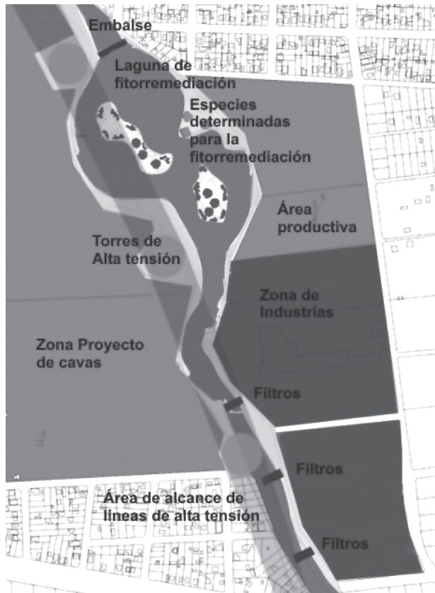
Figura 12: Laguna de Fitorremediación
