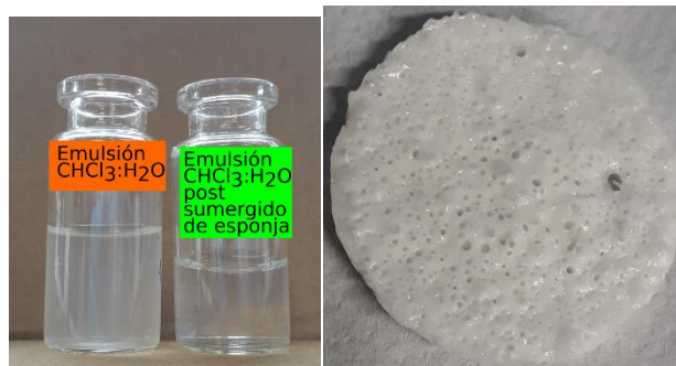
Figura 1. Absorción de solventes por esponjas preparadas con diferentes templates (izq.) y capacidad de ruptura de emulsiones de las emulsiones preparadas (cen.) y esponja (der.)
