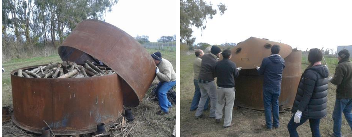
Figura 6.31. Montaje, carga y cierre del horno TPI-CTM. Fuente: propia (2018).
