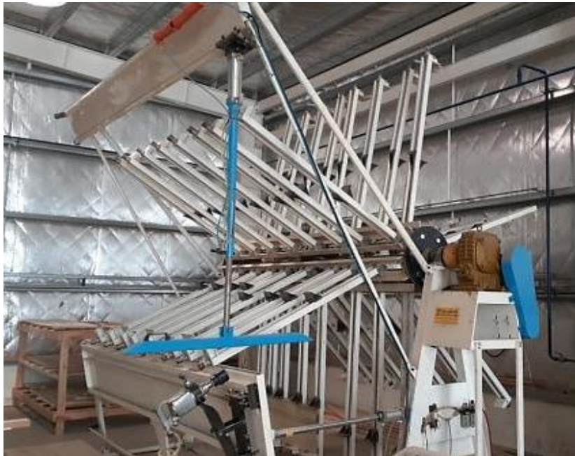
Figura 5.35. Prensa tablero de listones-CTM. Fuente: propia (2020).
