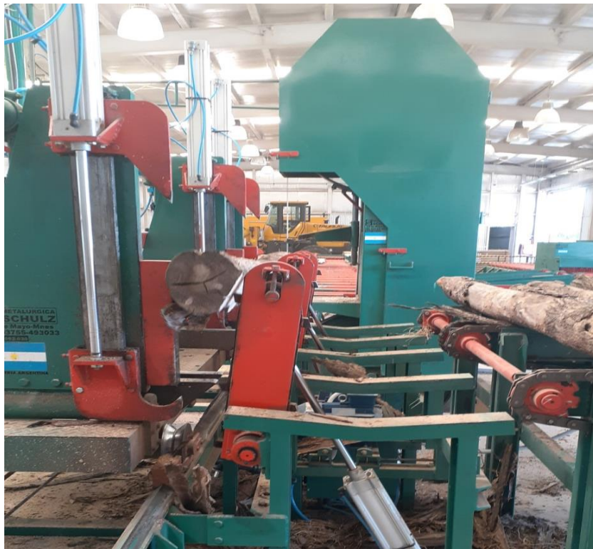
Figura 3.24. Trabajo de los volteadores de cadena-CTM. Fuente: propia (2020).
