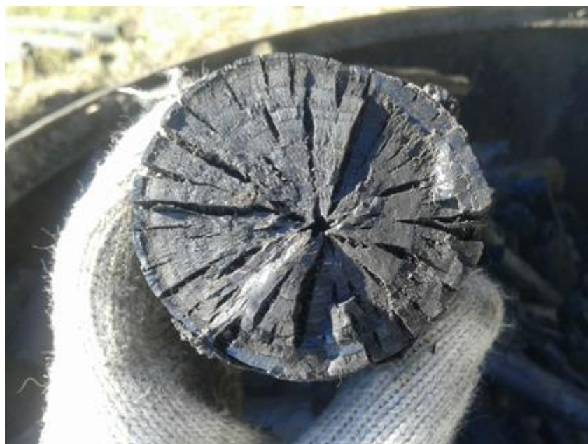
Figura 6.21. Carbón vegetal elaborado en horno-CTM.
