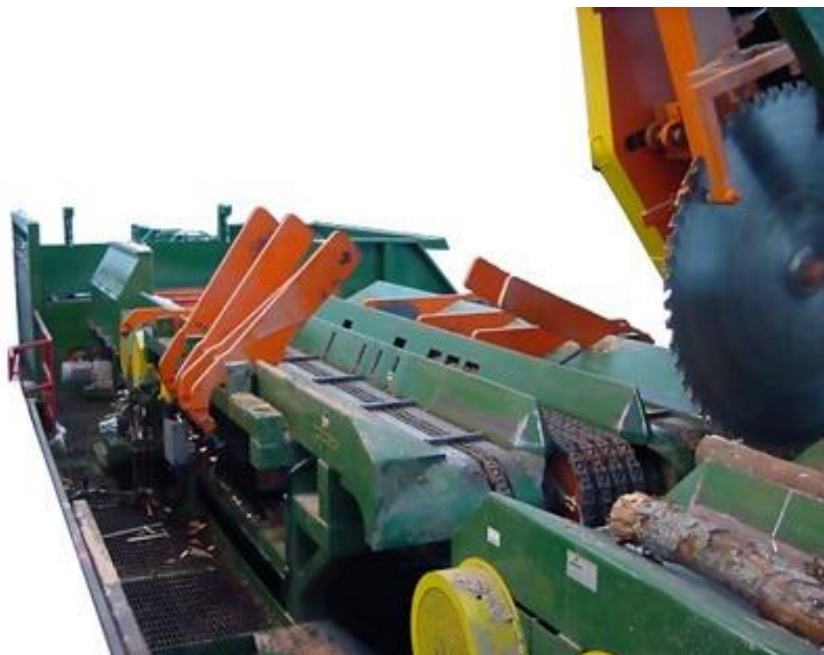
Figura 2.14. Tronzador de sierra circular. Fuente: Huertas Montes (2020) 13 .
