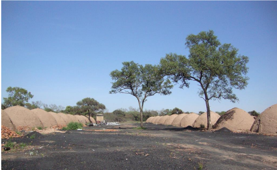
Figura 6.28. Serie de hornos de ladrillo “media naranja argentino” (Chaco). Fuente: propia (viaje de estudio Ing. Ftal., 2015).
