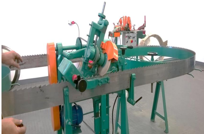
Figura 4.30. Proceso de pre-afilado-CTM. Fuente: propia (2019).
