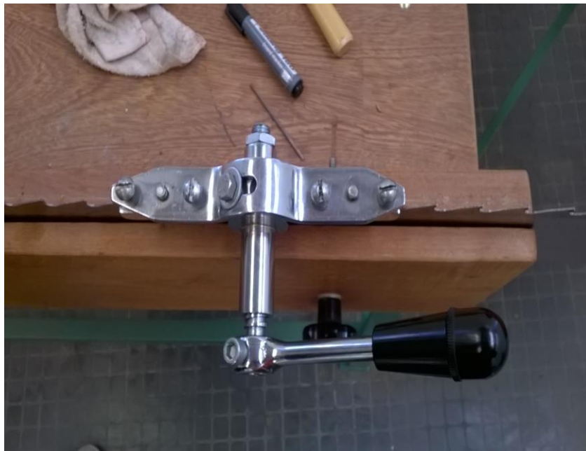
Figura 4.32. Igualadora sierra sinfin en banco de trabajo-CTM. Fuente: propia (2019).
