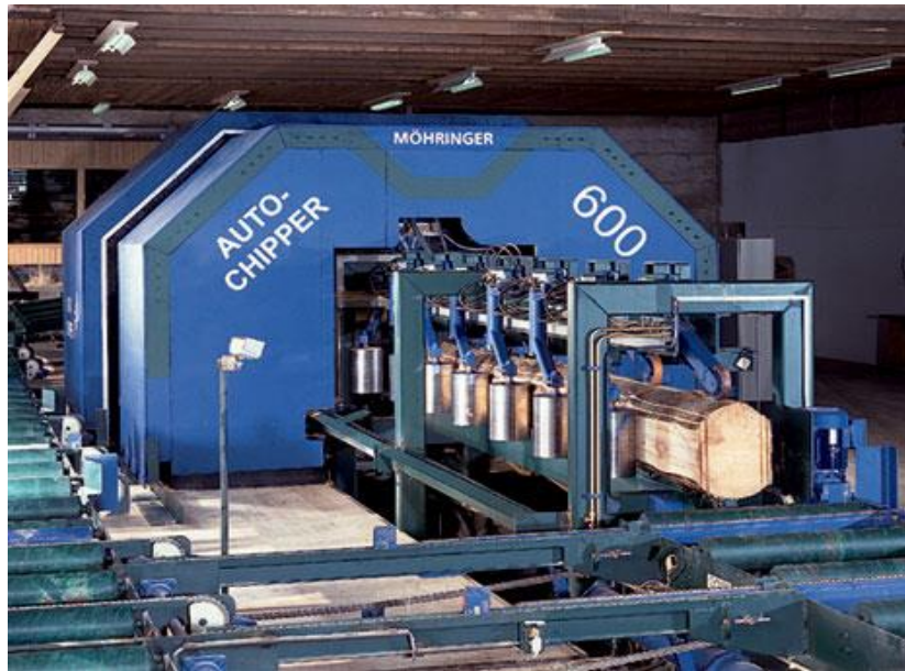
Figura 3.18. Equipo Chipper canter con 2 discos chipeadores. Fuente: Mohringer (sf) 14 .
