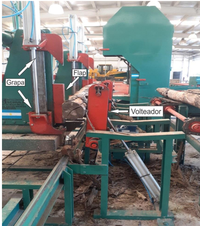
Figura 3.30. Grapas, flaps y volteadores en posición de trabajo-CTM. Fuente: propia (2020).
