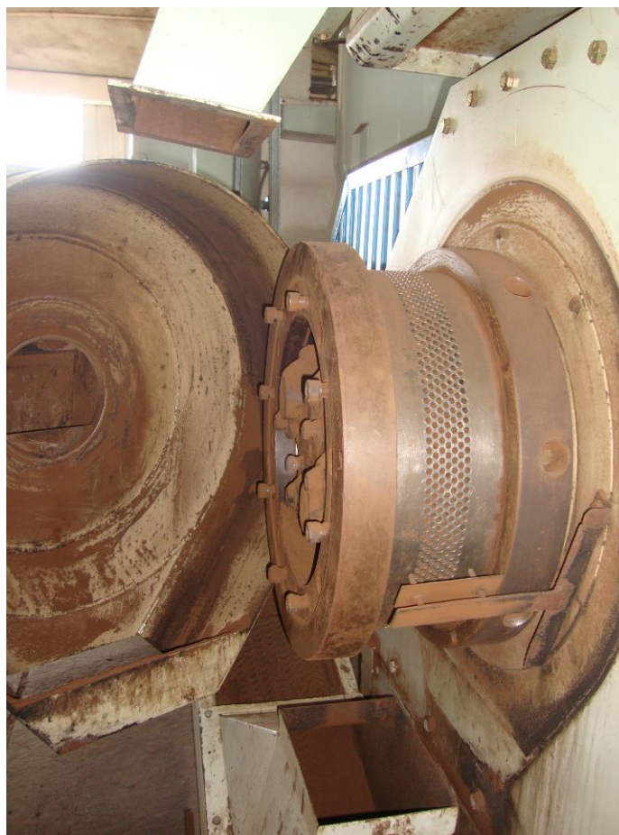
Figura 6.20. Matriz anular perforada de máquina pelletizadora (Presidencia de La Plaza, Chaco). Fuente: propia (viaje de estudio Ing. Ftal., 2015).
