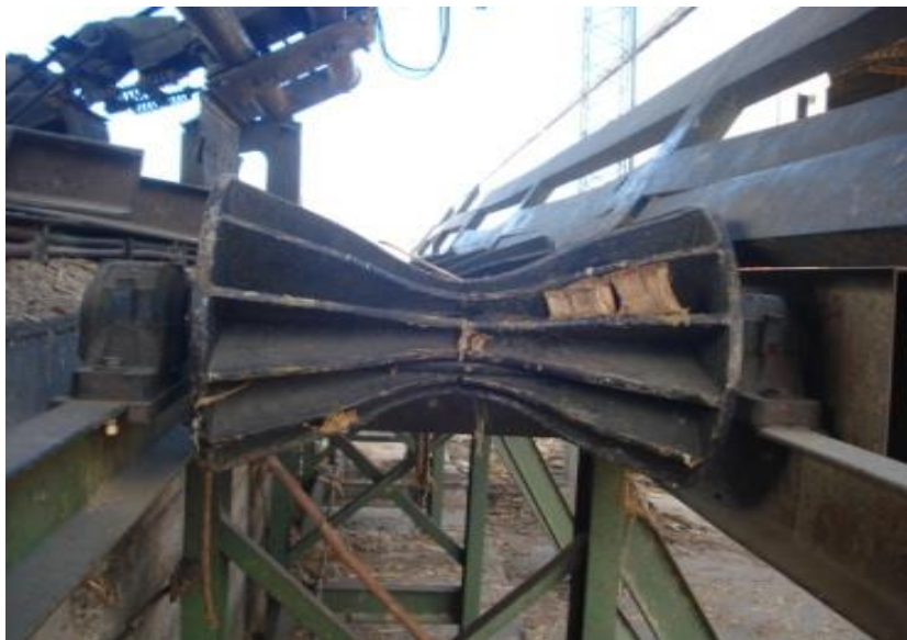
Figura 3.27. Rodillo tronco-cónico en aserradero (Ubajay, Entre Ríos). Fuente: propia (viaje de estudios Ing. Ftal., 2015).
