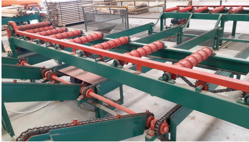
Figura 3.25. Cadena para el movimiento de madera aserrada-CTM. Fuente: propia (2020).
