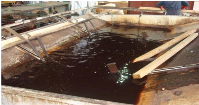
Figura 3.37. Proceso de inmersión en batea de baño antimancha (Abra Ancha, Neuquén). Fuente propia (viaje de estudios Ing. Ftal., 2007).
