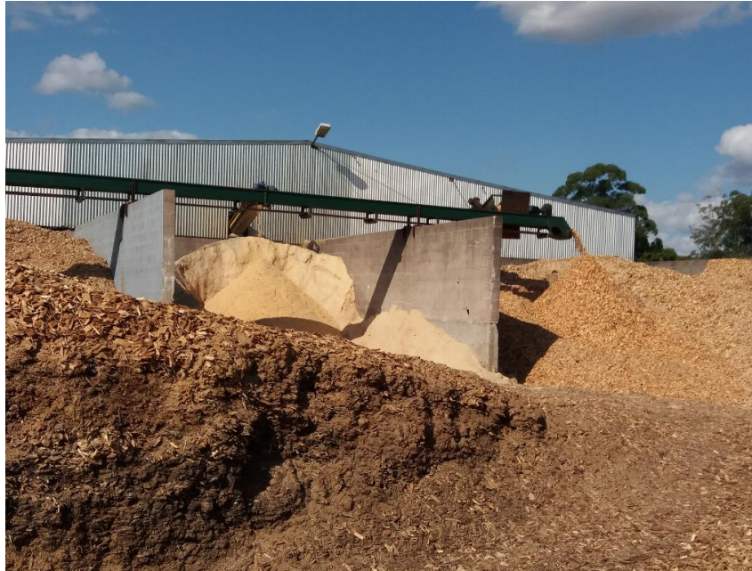
Figura 6.10. Residuos finos de transformación mecánica de madera de Eucalyptus spp. (Entre Ríos). Fuente: propia (viaje de estudio Ing. Ftal., 2019).
