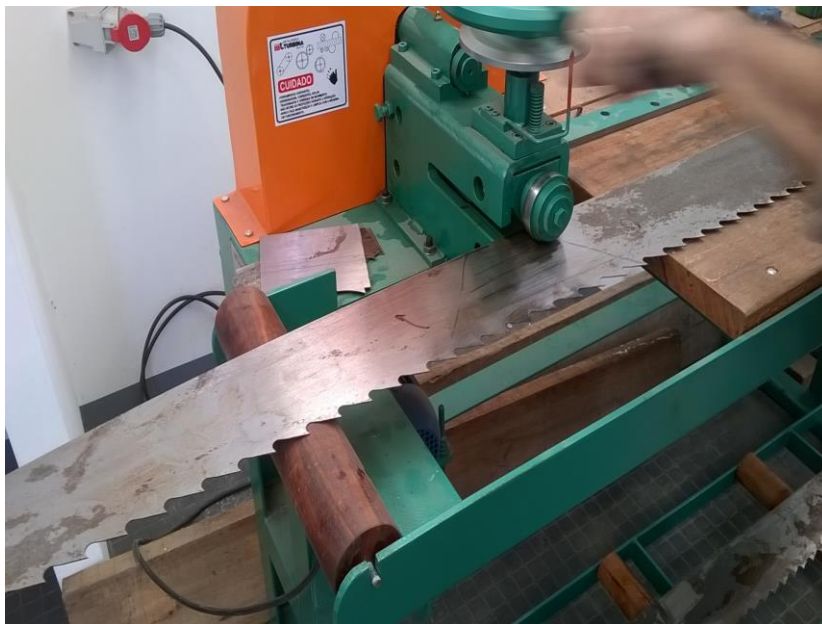
Figura 4.28. Proceso de laminado-CTM. Fuente: propia (2019).
