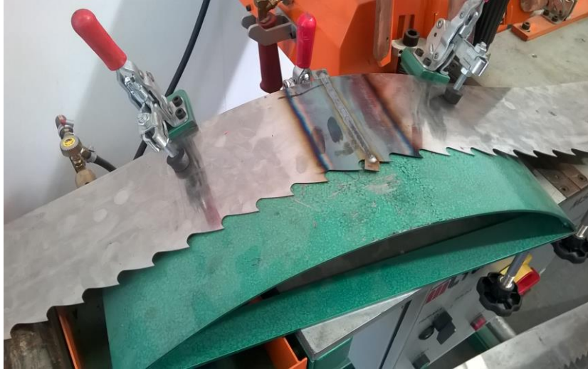
Figura 4.24. Cordón de soldadura-CTM. Fuente: propia (2019).
