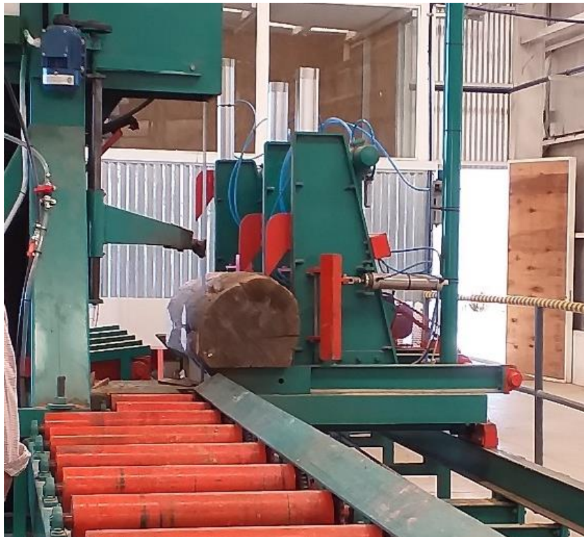
Figura 4.8. Aserrado por sistema de corte abierto-CTM. Fuente: Propia (2019).
