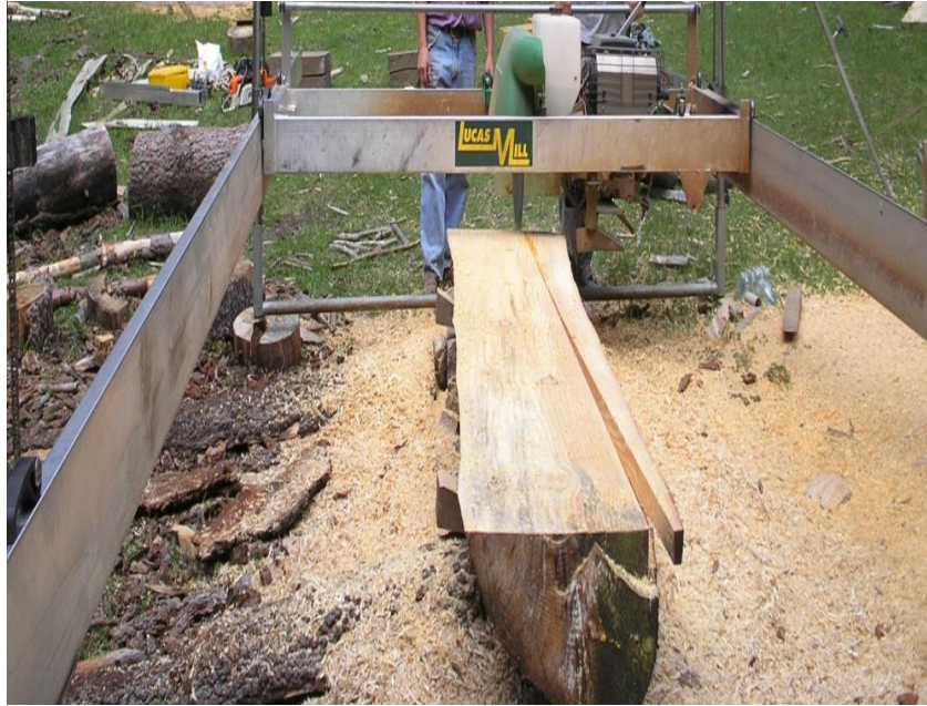
Figura 2.1. Aserradero portátil. San Martín de los Andes (Neuquén). Fuente: propia (viaje de estudios Ing. Ftal., 2008).
