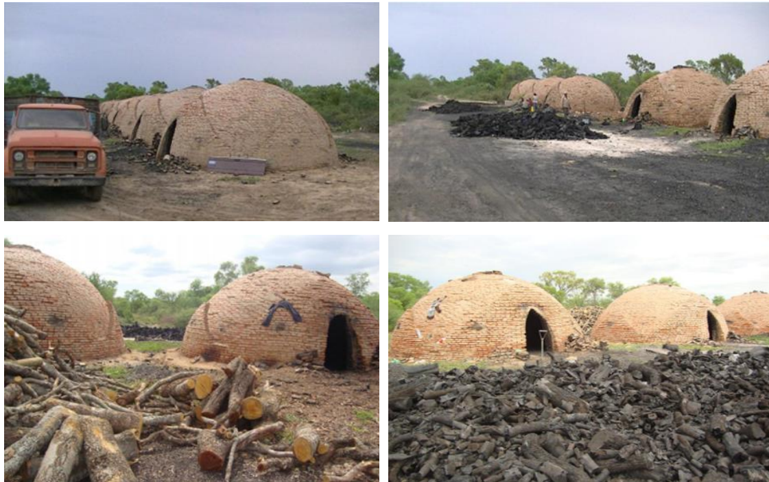
Figura 6.29. Hornos de ladrillo “media naranja argentino” en producción (Santiago del Estero). Fuente: propia (viaje de perfeccionamiento profesional para graduados, 2013).
