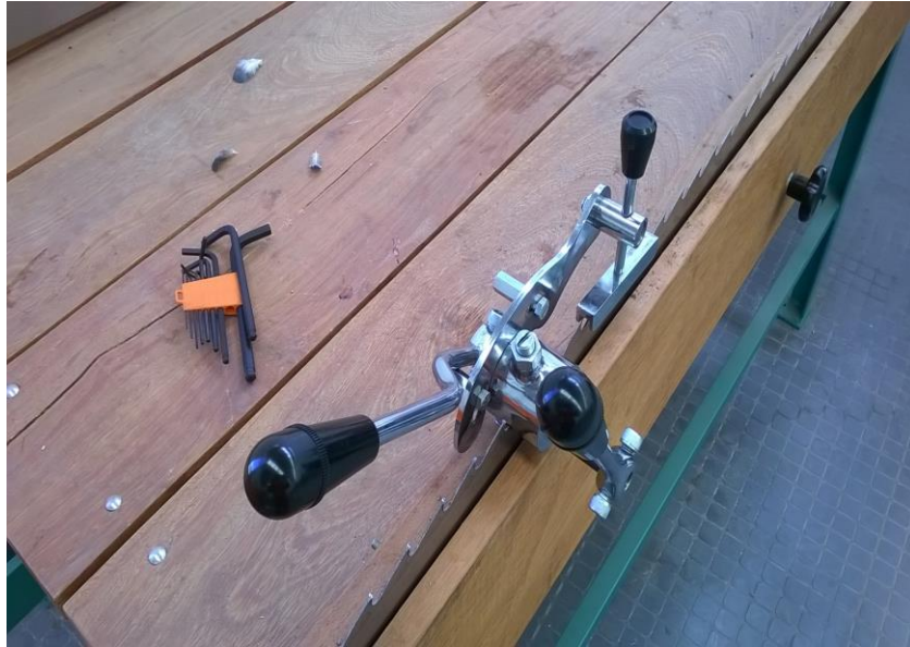
Figura 4.31. Recalcadora-CTM. Fuente propia (2019).
