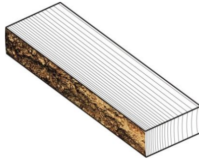
Figura 4.11. Aserrado de madera cuarteada. Fuente: Spavento (2015).
