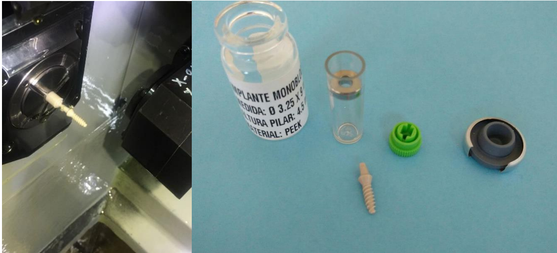
Implante realizado mediante torno CNC para la Facultad de Odontología de La Plata.
