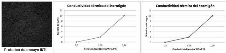
Figura 47: Probetas ensayadas y la Conductividad térmica de las probetas con diferentes proporciones de negro de humo (azul) y de ferrite color negro (rojo) en la masa térmica del hormigón.
