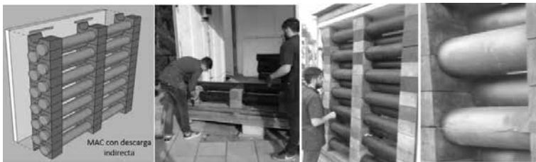
Figura 75. Ensayo de carga máxima. Prototipo "Dosbolillos" con descarga indirecta. (J. Jodra, 2021).
