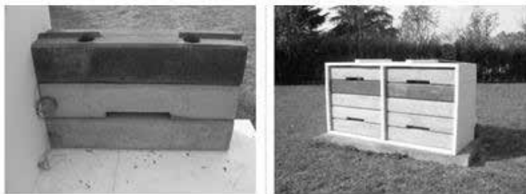
Figura 45. Piezas pigmentadas y sin pigmentar de los MAS Mixtos y Sólidos colocadas en los BOX de ensayo.
