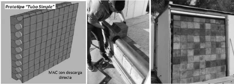
Figura 68. Imágenes de la configuración “tubo simple” con descarga directa, y su instalación en el módulo de ensayos
