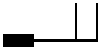
1 caño con 2 ramificaciones perpendiculares
