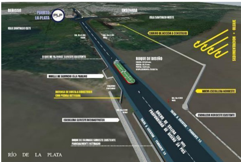
Ilustración 10 - Esquema Alternativa seleccionada. Elaboración propia con gráficos de Autocad sobre imagen de Google Earth.
