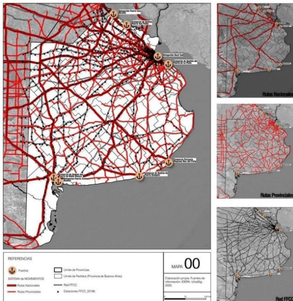
Figura 2. Infraestructuras de transporte terrestre. Elaboración propia según IDERA y URBASIG.
