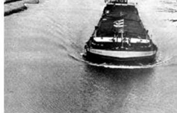
Ilustración 8 - Efecto del oleaje producido por embarcaciones sobre las costas. Fuente: Publicación del Bulletin N°88 of the Federal Waterways Engineering and Research Institute- Principles for the Design of Bank and Bottom Protection for Inland Waterways
