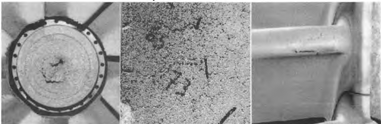
Figura 2. Daños ocasionados por combustión inestable
