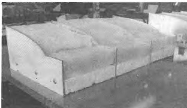
e. Relleno de Poliestireno y Poliuretano
