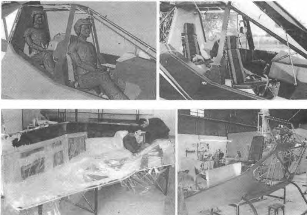
Figura 12. Modelo 3D y construcción de estructura monocasco de materiales compuestos.
