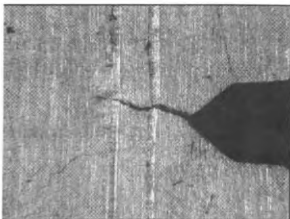
Figura 16. Se observa la entalla, la fisura y la zona deformada asociada en el Al 6061
