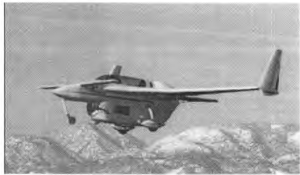
Figura 20 avión propulsado por PDE en vuelo
