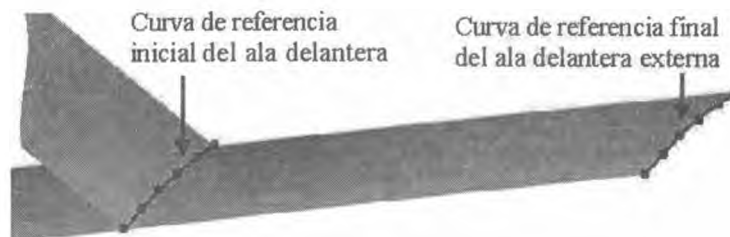
Figura 3. Curvas de referencia que delimitan la geometría del ala delantera externa.
