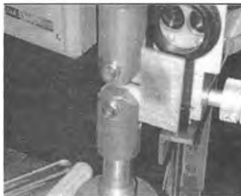
Figura 9. Probeta CT montada en la máquina de tracción servohidráulica MTS.
