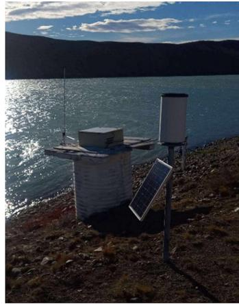
b. Estación metereológica Charles Fuhr – SIPH (sensor hidrométrico y pluviómetro)
