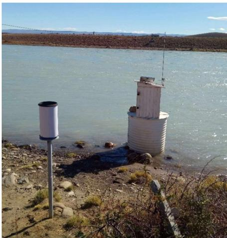
e. Estación hidrométrica y meteorológica La Leona – SIPH (sensor hidrométrico y pluviómetro)
