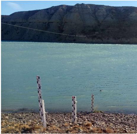
a. Estación hidrométrica Charles Fuhr – SIPH (escalas y antiguo cable para vagoneta)
