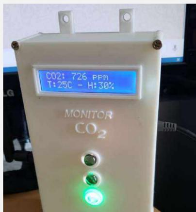
Fig 2.: Nodo de medición de Co2
