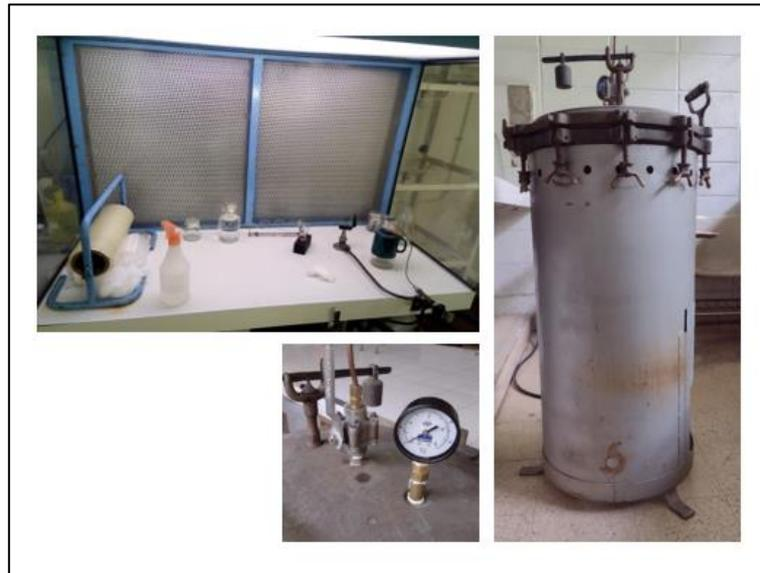
*Nota. Flujo laminar de aire estéril y autoclave usados en el laboratorio de cultivo de tejidos in vitro para trabajar en condiciones de asepsia. (Fuente propia).*
