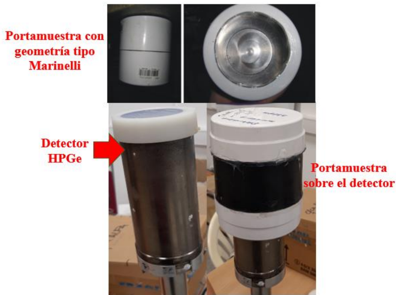
Figura 12.6. Geometría del conjunto muestra-detector en nuestro experimento. La geometría del portamuestra, que envuelve parcialmente al detector, se denomina Marinelli [Montes 2016].
