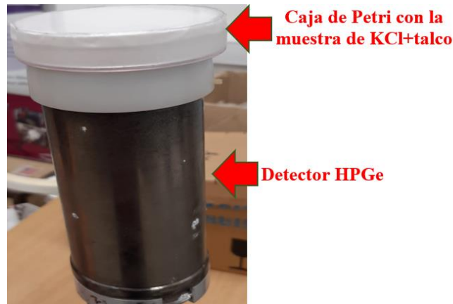
Figura 13.3. Geometría del experimento. Se distingue la caja de Petri con una de las muestras de KCl diluida de talco y el detector de HPGe. Para mayor claridad, el detector se retiró de la cámara limpia.
