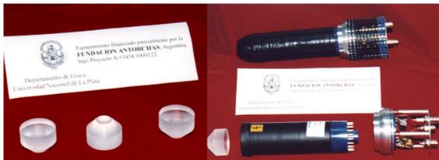
Figura 8.1: Diagrama esquemático de un sistema detector de radiación \gamma en base a un material centellador. En la fotografía inferior se muestran cristales centelladores ( BaF_2 ), un detector ya montado (derecha, arriba) y un detector y su tubo fotomultiplicador separados (derecha, abajo).
