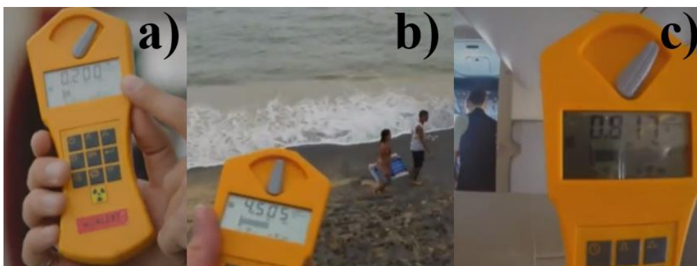
Figura 6.6. DEE determinadas en a) Berlín (0,20 \mu\text{Sv/h} , nivel del mar); b) Playas de Guarapari (45 \mu\text{Sv/h} ); c) en un avión a 5.000 m de altitud (0,8 \mu\text{Sv/h} ).
