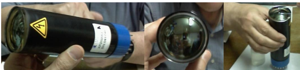
Figura 8.14. Tubo fotomultiplicador Philips XP2020Q. Podemos ver la ventana del tubo fotomultiplicador que se acopla ópticamente al material centellador.
