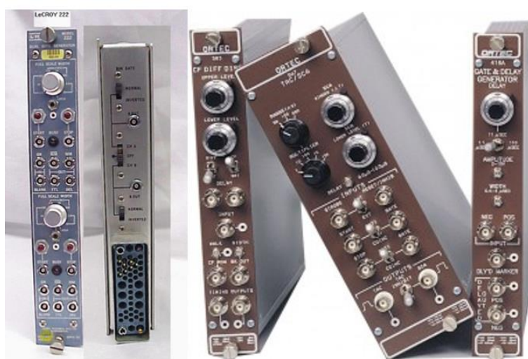
Figura 10.17. Módulos electrónicos construidos según la estandarización NIM. Se observan módulos de ancho simple y doble y un módulo visto desde atrás para visualizar los conectores eléctricos.
