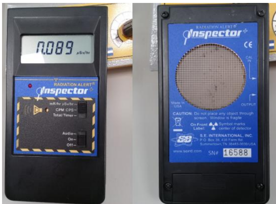
Figura 7.4. Foto de la parte frontal (izquierda) y de la parte trasera (derecha) del detector Geiger-Müller marca Inspector. En la foto de la parte trasera se observa la ventana y, en la parte inferior, el compartimento para la batería de 9 V que alimenta al detector.
