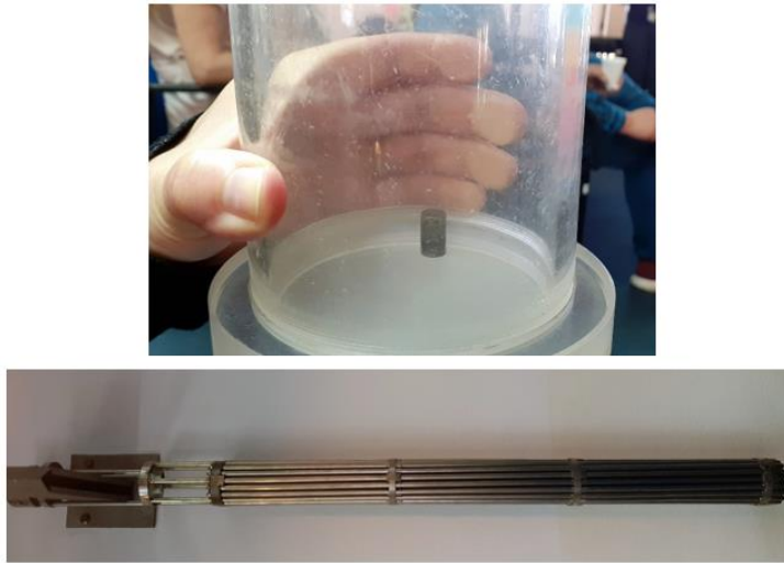
Figura 5.1. Combustible nuclear en forma de pastilla de material compactado empleado en la central nuclear Atucha (arriba) y vainas de Zr donde se introducen para formar las barras de combustible
