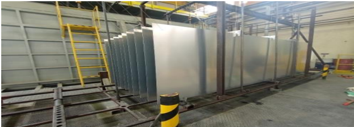
Figura 3. Disposición de chapas de aluminio 2219-T851 previo a recocido total.
