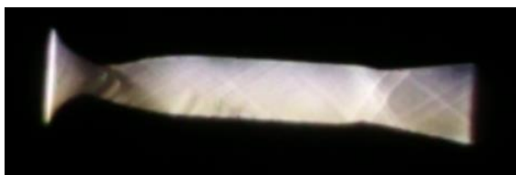
Figura 12. Visualización de Sección de prueba mediante método Schlieren en “funcionamiento”
