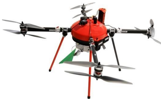
Figura 8. Drone Colibrex, hélices contra rotativas.
