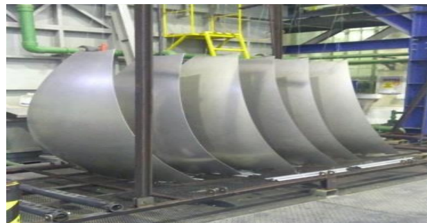
Figura 9. Disposición de piezas conformadas y contorneadas previas a tratamiento térmico de envejecido en caliente.
