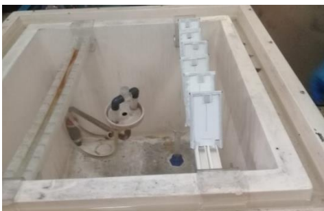
Figura 5. Probetas en el interior de la cámara de niebla salina.
