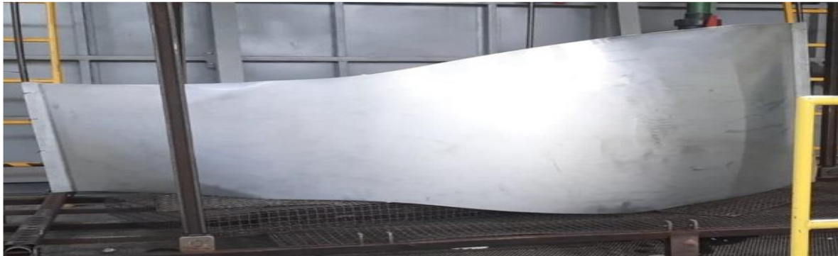
Figura 6. Disposición de pieza conformada previo a tratamiento térmico de solubilizado.
