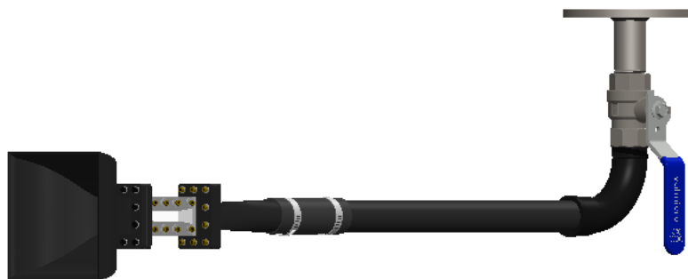
Figura 8. Túnel de viento con instalación al reservorio
