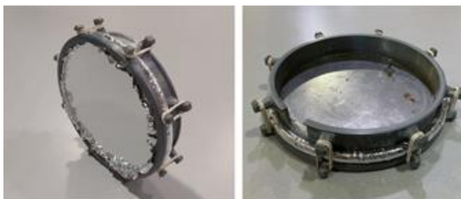
Figura 8. Ensamble de piezas, Mylar, estructura impresa en 3D y placa rígida sujetas con goma elástica.
