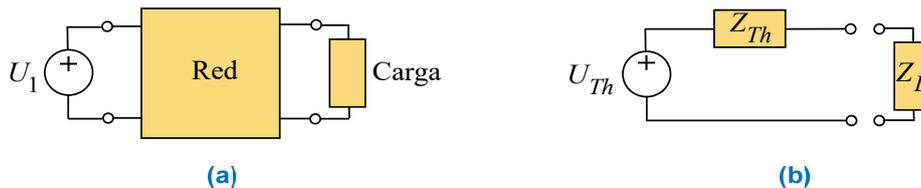
**Fig. 3.1.** (a) Carga conectada a la fuente a través de una red de dos puertos. (b) Modelo Thevenin de la red y la fuente.
