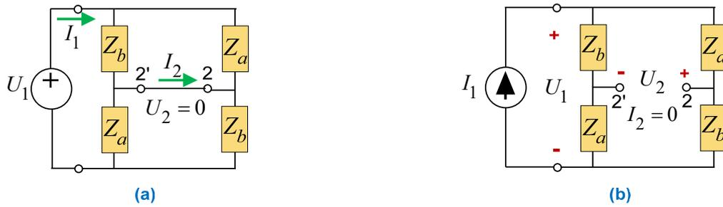
Fig. 1.17. Celdas lattice o celosía: (a) circuito para determinar  $y_{11}$  e  $y_{21}$ ; (b) circuito para determinar  $z_{11}$  e  $z_{21}$ .
