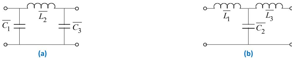
**Fig. 9.25.** Topologías posibles del filtro PBN: **(a)** sintetizado como admitancia; **(b)** sintetizado como impedancia.
