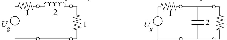
Fig. 9.37. Valores de los elementos del PBN resultantes a partir de  $\rho_{1a}=\rho_{1b}$ : (a) síntesis como impedancia; (b) síntesis como admitancia.
