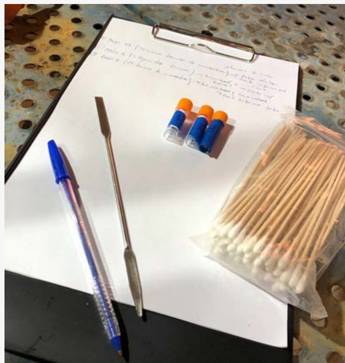
Toma de material de los paneles y de la estructura para análisis en laboratorio. Parroquia-Santuario Medalla Milagrosa.
