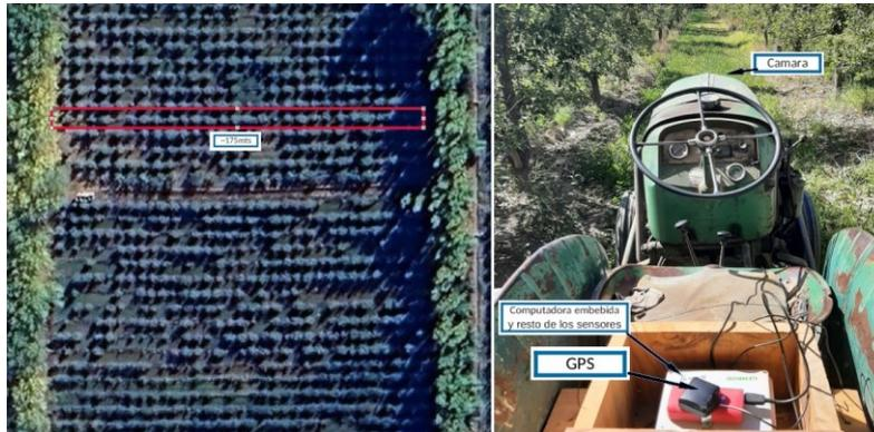
Figura3: Izquierda: Vista del recorrido. Derecha: Tractor con la caja adquisidora.
