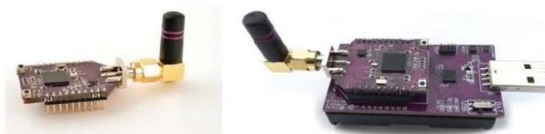
**Figura 1.** Nodo sensor (izquierda) y nodo coordinador (derecha).
