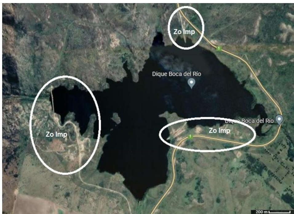
Figura 3. Embalse Boca de Río, San Luis, Argentina. En los círculos se remarcan las zonas más impactadas relacionadas a las antiguas zonas de obra para la construcción del embalse y desvío de la Ruta Provincial 1. Zo Imp., zonas impactadas (Fuente: Elaboración propia).
