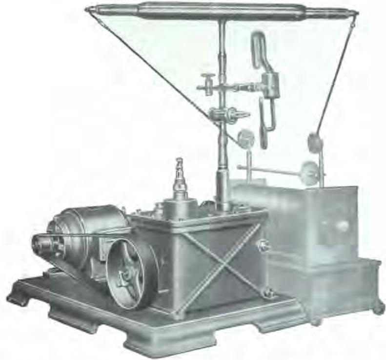
Bomba rotativa, modelo Duplex, con motor no. 110 11/13, pieza de unión de vidrio no. 554 02, vacuscopio no. 160 23, pág. 61, tubo de descarga no. 554 11, alimentada por un carrito de inducción no. 521 11, pág. 184.
