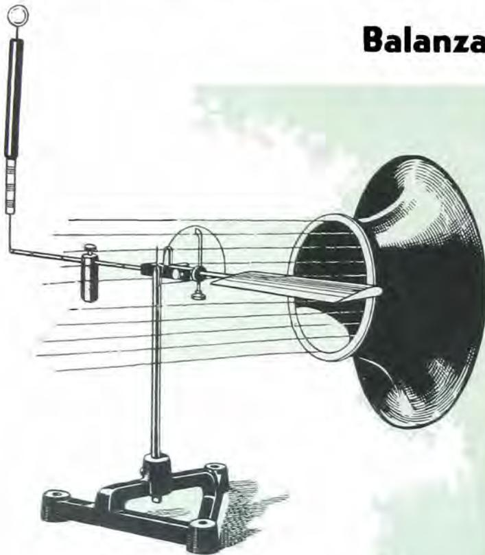
Balanza de dos componentes no. 373 30 con dinamómetro y ala colocada en la corriente de aire del canal.
