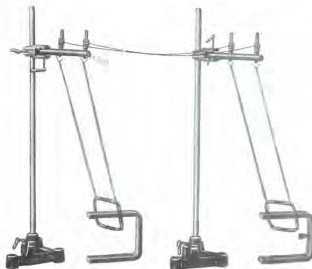
Si se unen los dos péndulos y se deja oscilar uno en el campo magnético del imán, la corriente alterna inducida provoca una oscilación igual del otro. Ello a condición de que los dos péndulos tengan las mismas características y el mismo largo.
