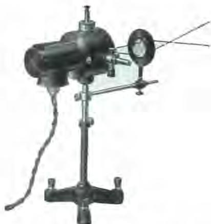
Fig. 1. Electroscopio universal de Wulf no. 546 01 con dispositivo de alumbrado no. 546 02.
