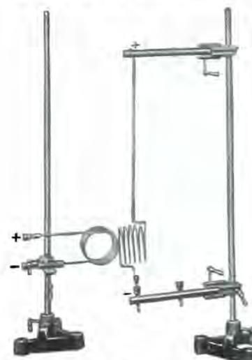
Las líneas de fuerza del campo magnético de la bobina (móvil) recorrida por una corriente tratan de superponerse con las de la bobina fija. Si, al principio, estas líneas de fuerza son orientadas perpendicularmente unas con relación a las otras, resulta de ello una rotación.
