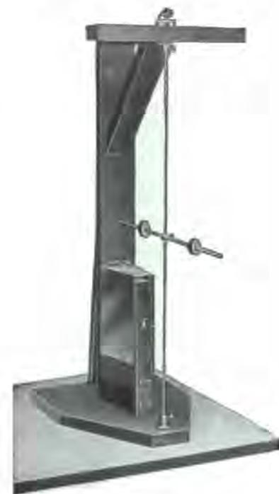
Fig. 12. Torsión elástica, momento de inercia, relación entre la fuerza directriz, el momento de inercia y el período de oscilación.
