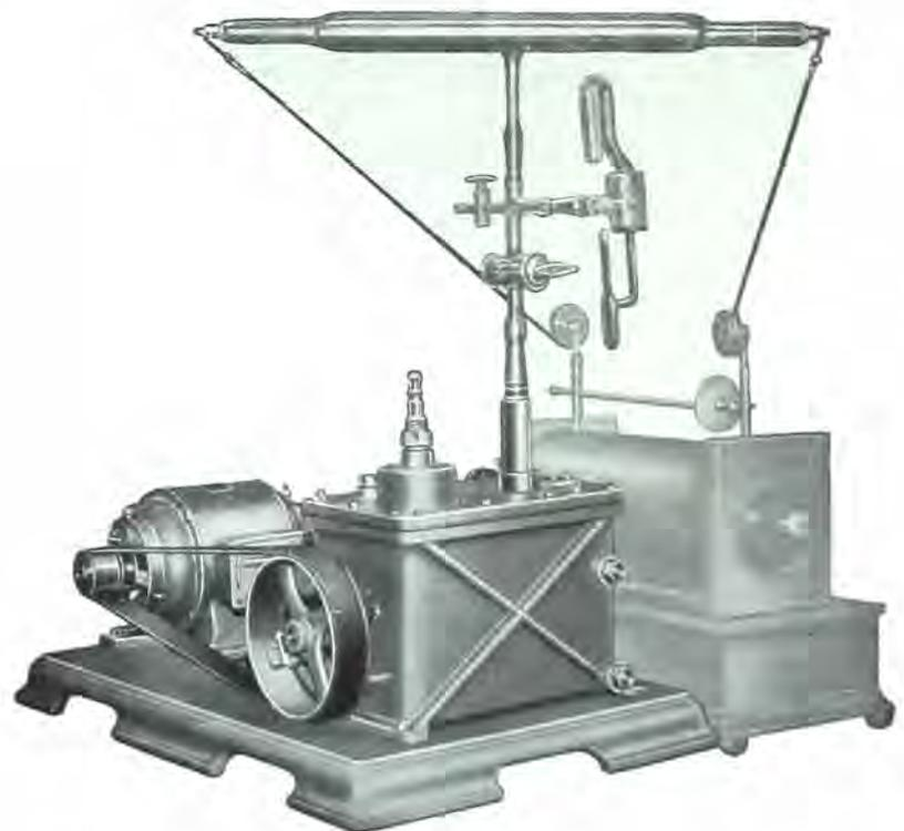
La ilustración de arriba representa la combinación de una bomba con un tubo de descarga y con un carrete de chispa.
