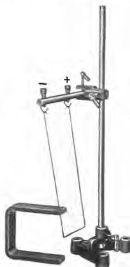
Si se envía una corriente a un conductor, éste es desviado en la dirección indicada, o en la dirección inversa, según el sentido de la corriente.
