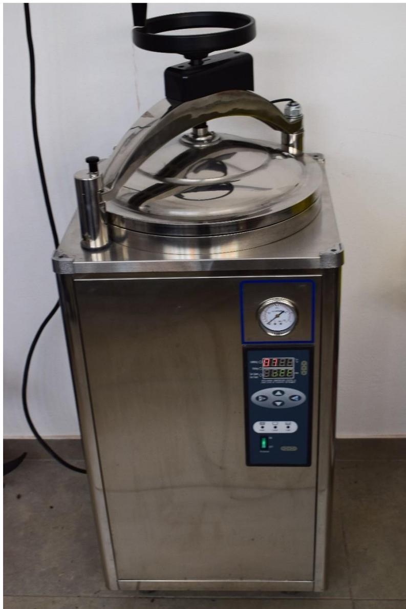
Figura 3.6. Autoclave semiautomática de 50 l.
