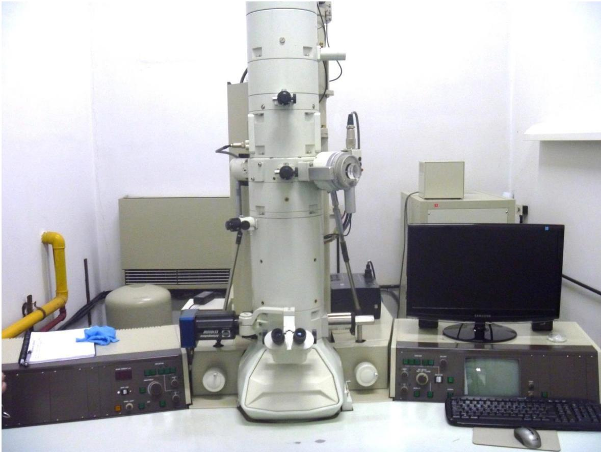
Figura 2.47. Microscopio electrónico.
