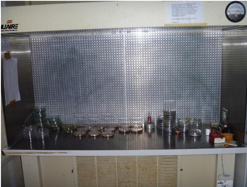
Figura 3.17. Cabina de flujo laminar de tipo horizontal.
