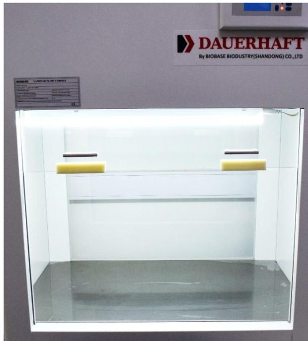
Figura 3.16. Cabina de flujo laminar de tipo vertical.
