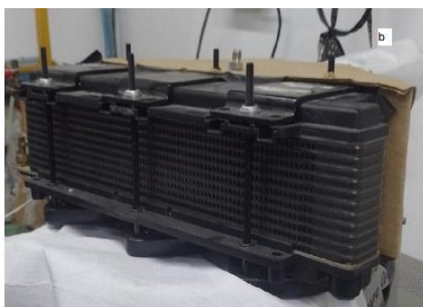
Figura 30. a) Electrolizador PEM, b) Celda de combustible PEM
