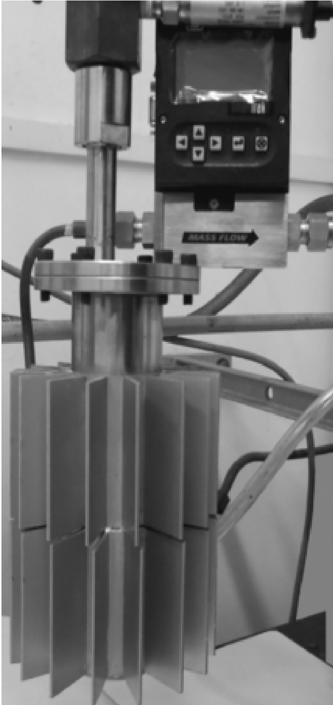
Figura 19. Almacenador de hidrógeno con controlador de flujo másico.
