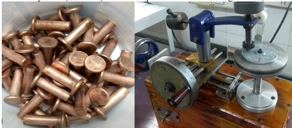
Figura 1. (a) Recubrimientos de cobre obtenidos con Cu-glutamato (b) Tribómetro ball-on-disk
