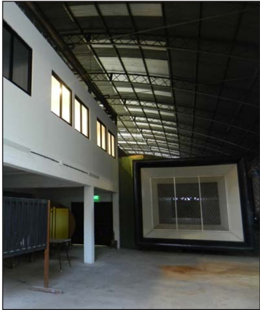
► Túnel aerodinámico abierto cuyas dimensiones son: 24 m de longitud, 2,6 m de altura y 1,83 m de ancho. Potencia instalada: 135 HP. Velocidad máxima: 30 m/s. (La.C.L.y.F.A.)
