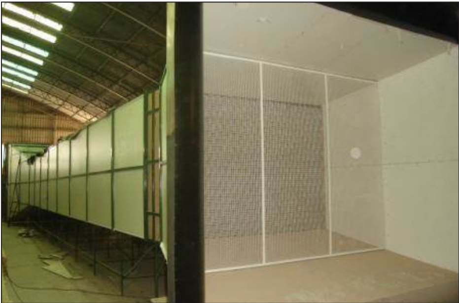
► Túnel aerodinámico abierto cuyas dimensiones son: 24 m de longitud, 2,6 m de altura y 1,83 m de ancho. Potencia instalada: 135 HP. Velocidad máxima: 30 m/s. (La.C.L.y.F.A.)
