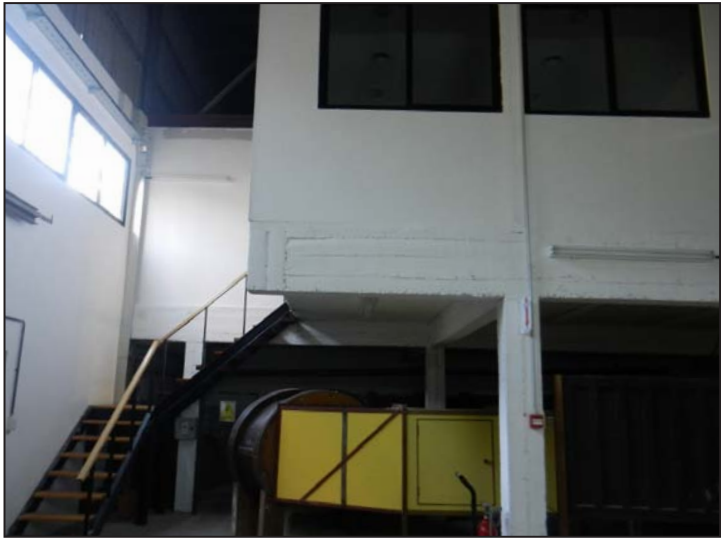
► Túnel aerodinámico de circuito cerrado. Velocidad controlable continuamente hasta un máximo de 20 m/seg. (La.C.L.y.F.A.)
