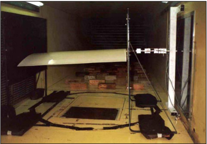
Estudios experimentales realizados en el control del flujo turbulento sobre perfiles aerodinámicos de bajo Reynolds con miniflaps tipo Gurney. (La.C.L.y.F.A.)
