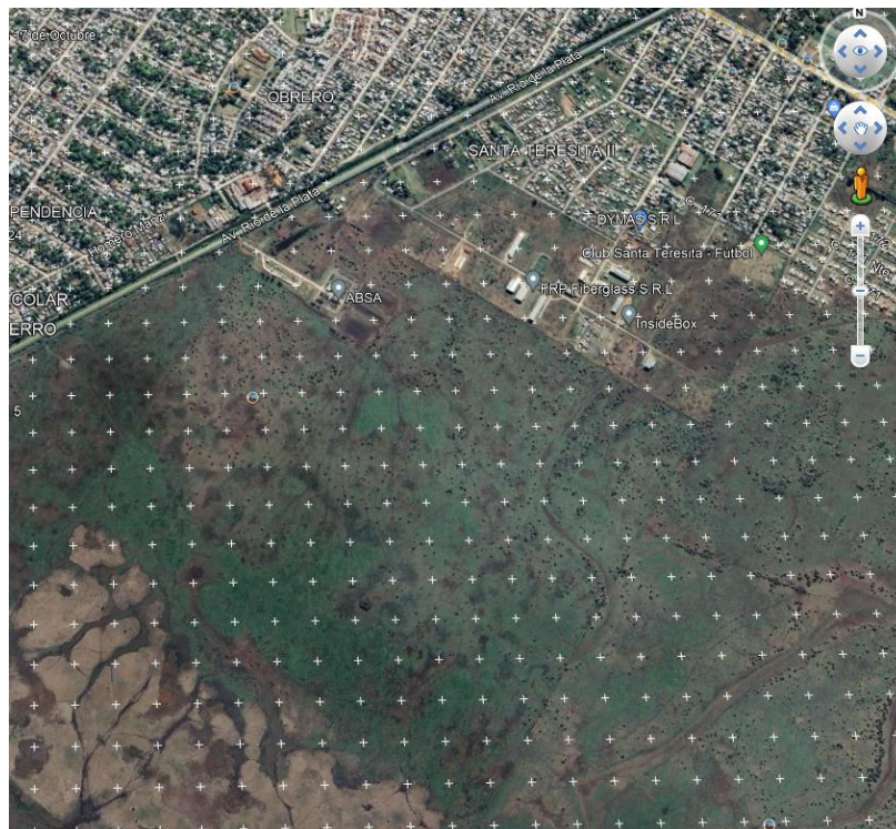
Figura 4.11: Grilla de receptores con paso de 50 metros
