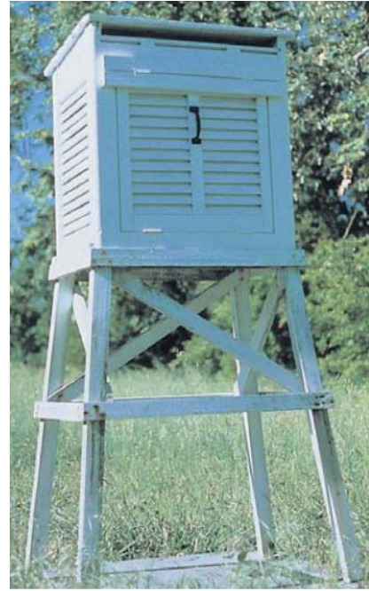
Figura N° 3.5: "Refugios o abrigo meteorológico para los instrumentos, como el que se muestra aquí, sirven como un lugar sombreado para los termómetros. Los termómetros dentro de los refugios miden la temperatura del aire; mientras que los termómetros expuestos directamente al sol no lo hacen".
