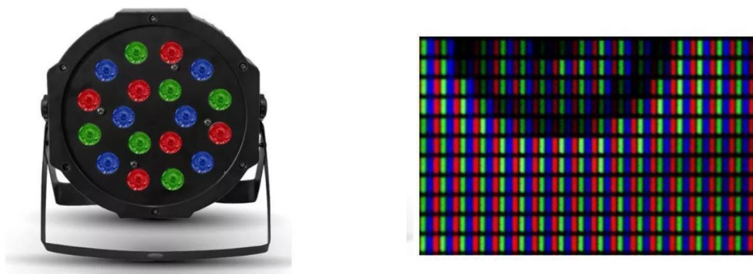
Figura 12.7. Luminaria led RGB (izquierda) y macrofotografía de los píxeles de una pantalla de celular (derecha)
