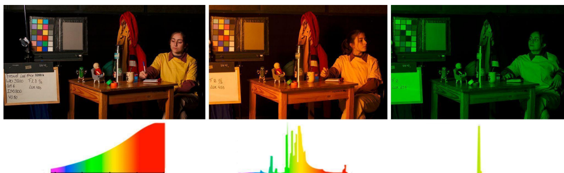
Figura 12.3. Luz incandescente, IRC 100 (izquierda); luz de vapor de sodio de alta presión, IRC 25 aprox (Centro); luz coloreada, IRC 1 (derecha). Debajo sus representaciones espectrales
