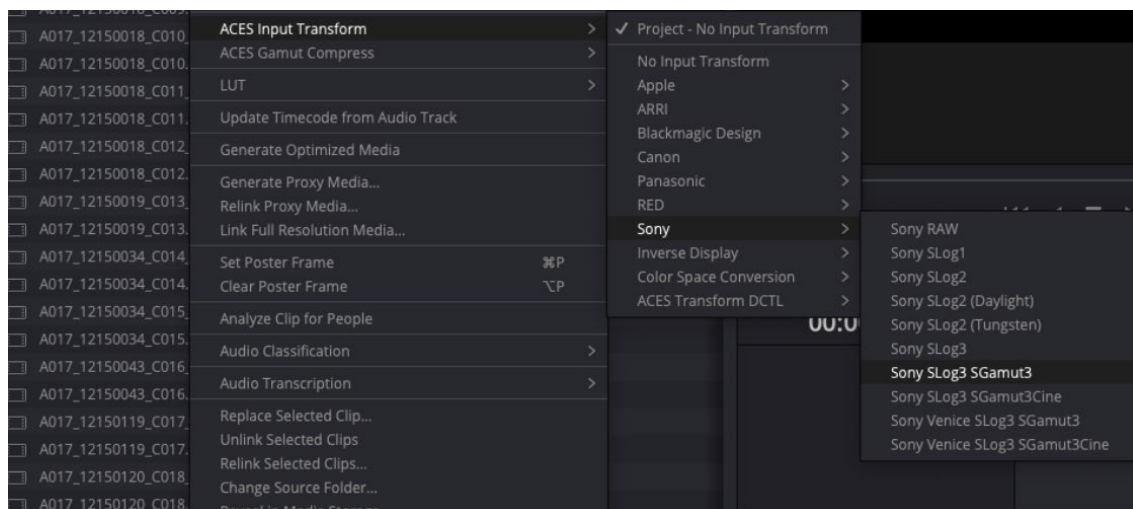
Figura 24.4. Asignación de IDT por clip en el software DaVinci Resolve
