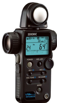
Figura 11.1. Fotómetro digital Sekonic L-758C. Realiza mediciones de luz incidente y también de luz reflejada.
