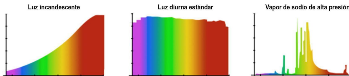
Figura 12.2. Representación espectral de las fuentes de luz. En el eje horizontal se muestran las longitudes de onda del espectro visible y en el eje vertical la irradiancia (intensidad)
